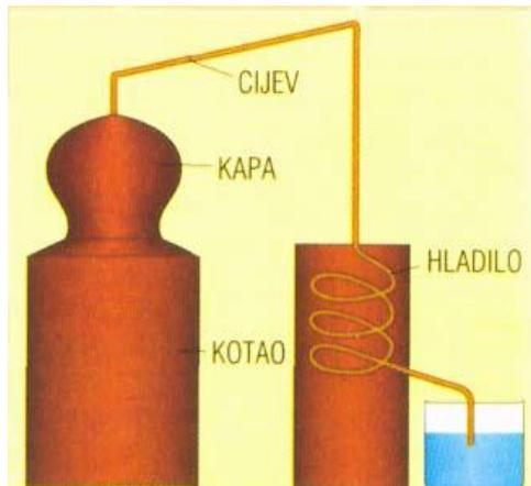
*Slika 3. Shematski prikaz jednostavnog (klasičnog) uređaja za destilaciju [18]*
