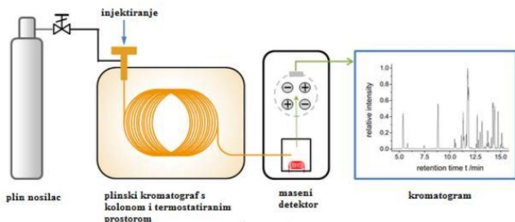
*Slika 10. Shematski prikaz vezanog sustava plinska kromatografija-spektrometrija masa*
