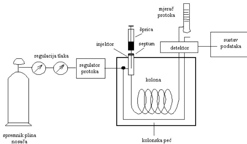
Slika 8. Shematski prikaz uređaja za plinsku kromatografiju [39]
