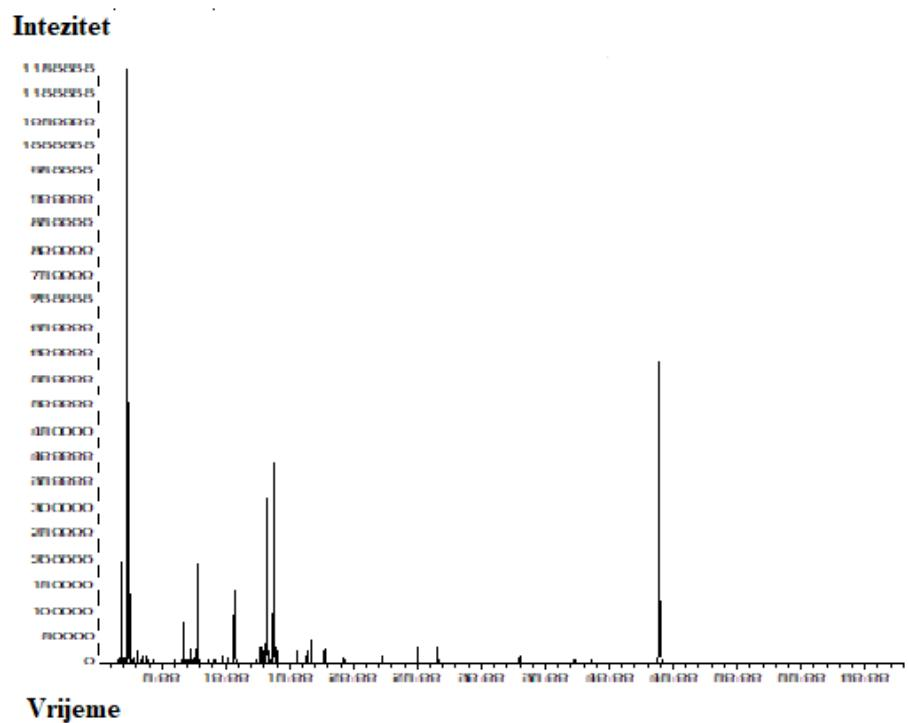
*Slika 22. Kromatogram ukupne ionske struje hlapljivih spojeva domaćeg likera od naranče izoliranih pomoću HS-SPME korištenjem pink vlakna*
