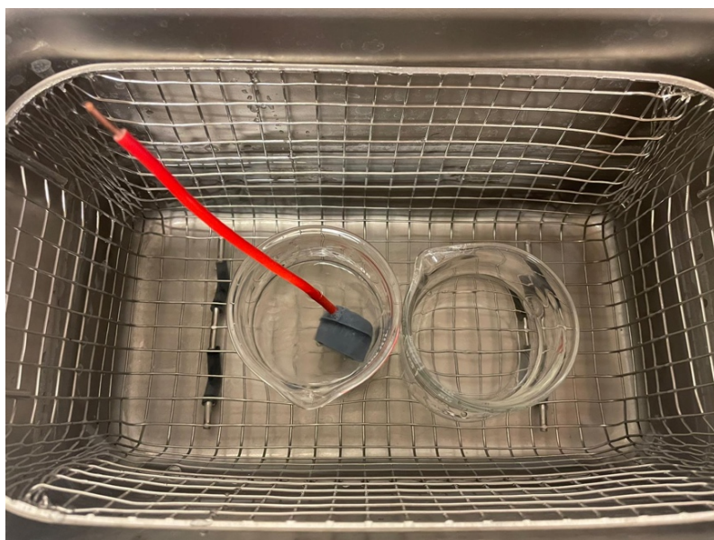
Slika 19. Čišćenje elektrode u ultrazvučnoj kupelji
