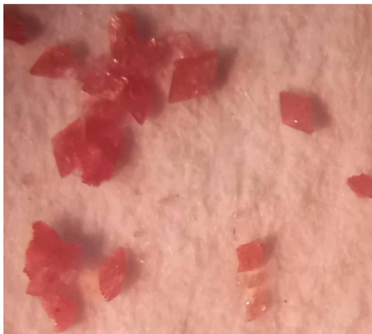
Slika 41. Prikaz kobaltonih kristala s 2–hidroksinikotinskom kiselinom pod svjetlosnim mikroskopom
