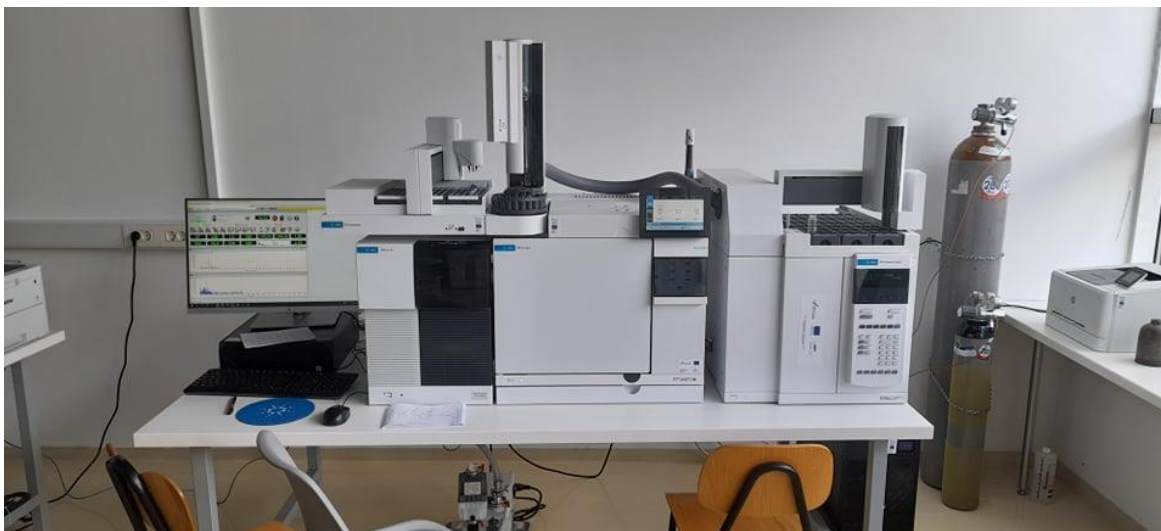
Slika 2.6. Fotografija korištenog GC-MS spregnutog sustava.
