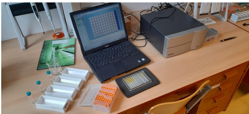
Slika 2.12. Provođenje Ellman-ovog testa pomoću čitača mikrotitarskih pločica.
