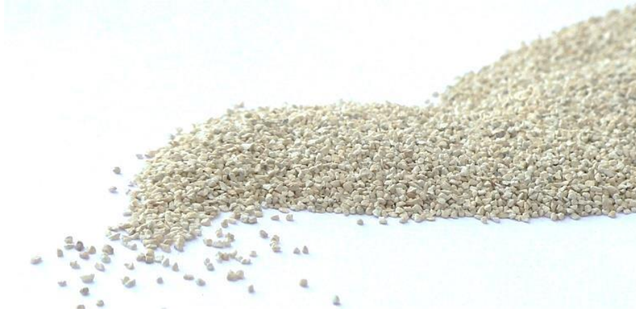
Slika 2.1. Prirodni zeolit klinoptilolit veličine čestica 0,6 - 0,8 mm.
