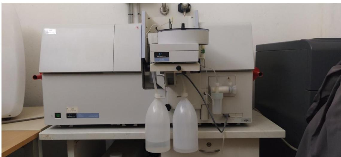
Slika 2.11. Atomski apsorpcijski spektrometar
