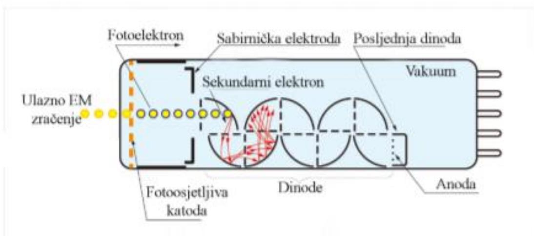
Slika 1.17. Shematski prikaz fotomultiplikatora [42]
