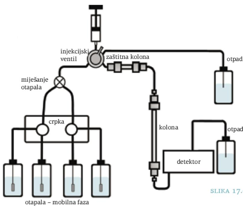
SLIKA 17.9. Shematski prikaz tekućinske kromatografije visoke djelotvornosti
