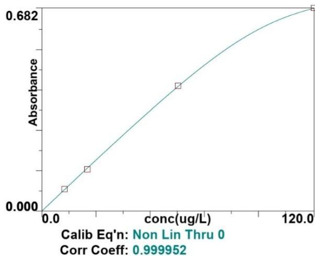
Slika 3.8. Krivulja umjeravanja za određivanje koncentracije željeza
