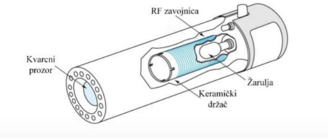
Slika 1.15. Bezelektrodna žarulja [40]
