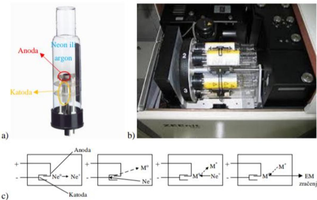
Slika 1.14. a) Žarulja sa šupljom katodom; b) Sustav sa više žarulja u jednom uređaju;
