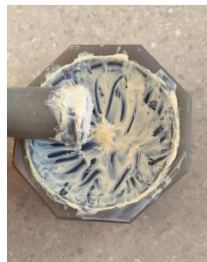
**Slika 23.** Pripremljena pasta nanokristaličnog praha ZnO s alkoholom
