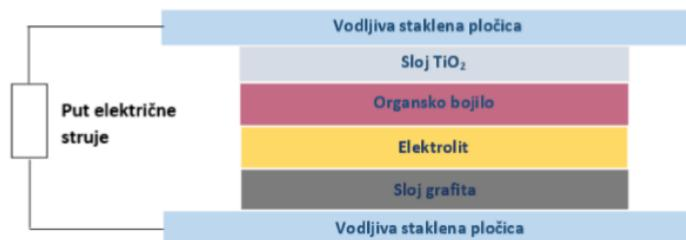
**Slika 16.** Shematski prikaz Grätzelove solarne celije<sup>29</sup>
