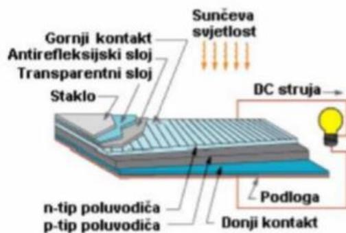
**Slika 4.** Spajanje PN spoja vanjskim strujnim krugom<sup>13</sup>
