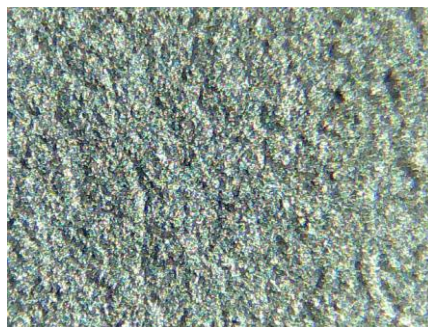
Slika 35. Izgled grafitnog sloja nakon pečenja, povećanje 10X
