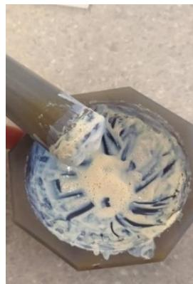
**Slika 22.** Pripremljena pasta nanokristaličnog praha ZnO s kiselinom
