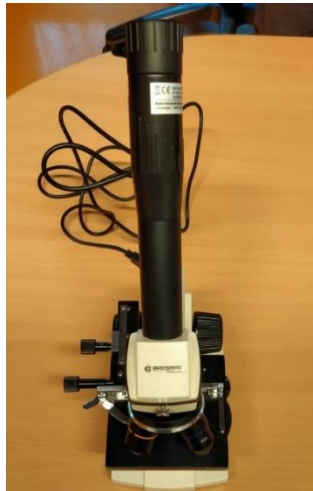
Slika 31. Mikroskop korišten za snimanje površine poroznog sloja i grafita
