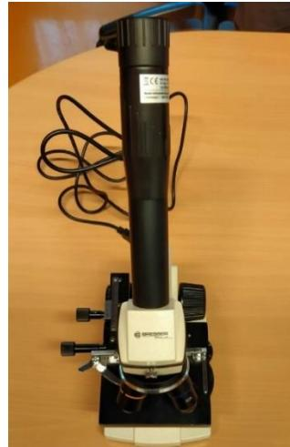
**Slika 31.** Mikroskop korišten za snimanje površine poroznog sloja i grafta
