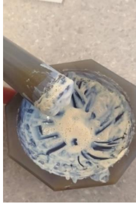
Slika 22. Pripremljena pasta nanokristaličnog praha ZnO s kiselinom
