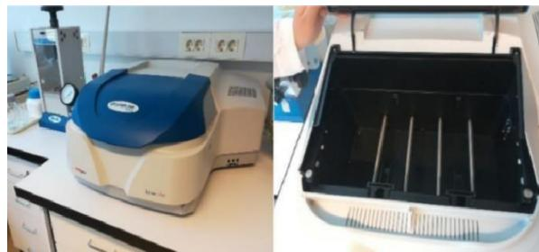
**Slika 32.** UV-Vis spektrofotometar Specord 200 Plus
