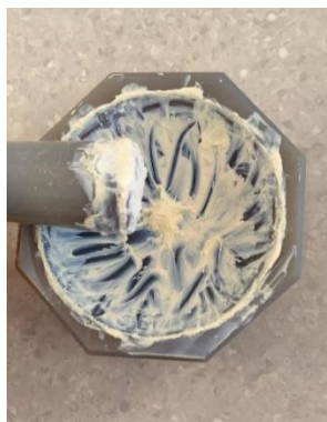
Slika 23. Pripremljena pasta nanokristaličnog praha ZnO s alkoholom
