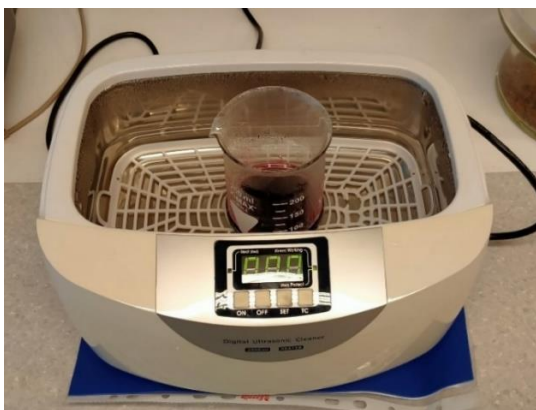
Slika 20. Potpomognuta ekstrakcija antocijanina u ultrazvučnoj kupelji
