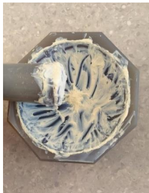
Slika 23. Pripremljena pasta nanokristaličnog praha ZnO s alkoholom
