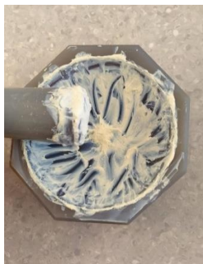
Slika 23. Pripremljena pasta nanokristaličnog praha ZnO s alkoholom
