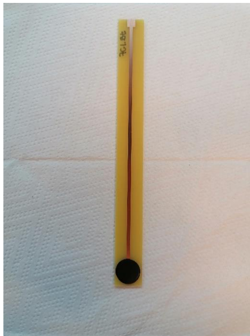
Slika 7. Tijelo elektrode zajedno s postavljenom membranom
