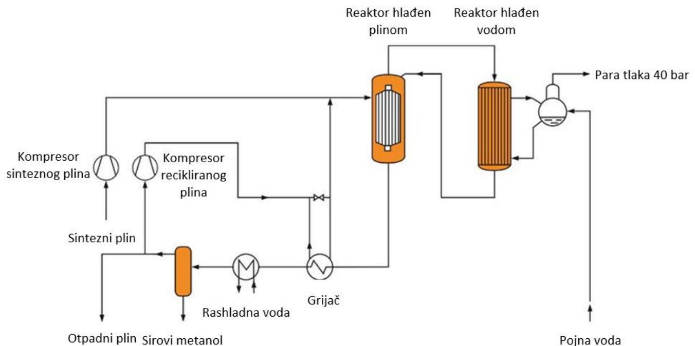
**Slika 2.** Lurgi dvostupanjski sustav proizvodnje metanola<sup>12</sup>
