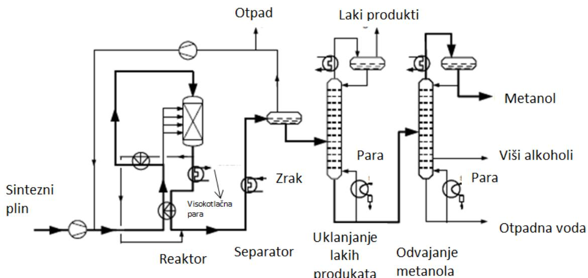
**Slika 1.** Shema ICI procesa proizvodnje metanola<sup>11</sup>
