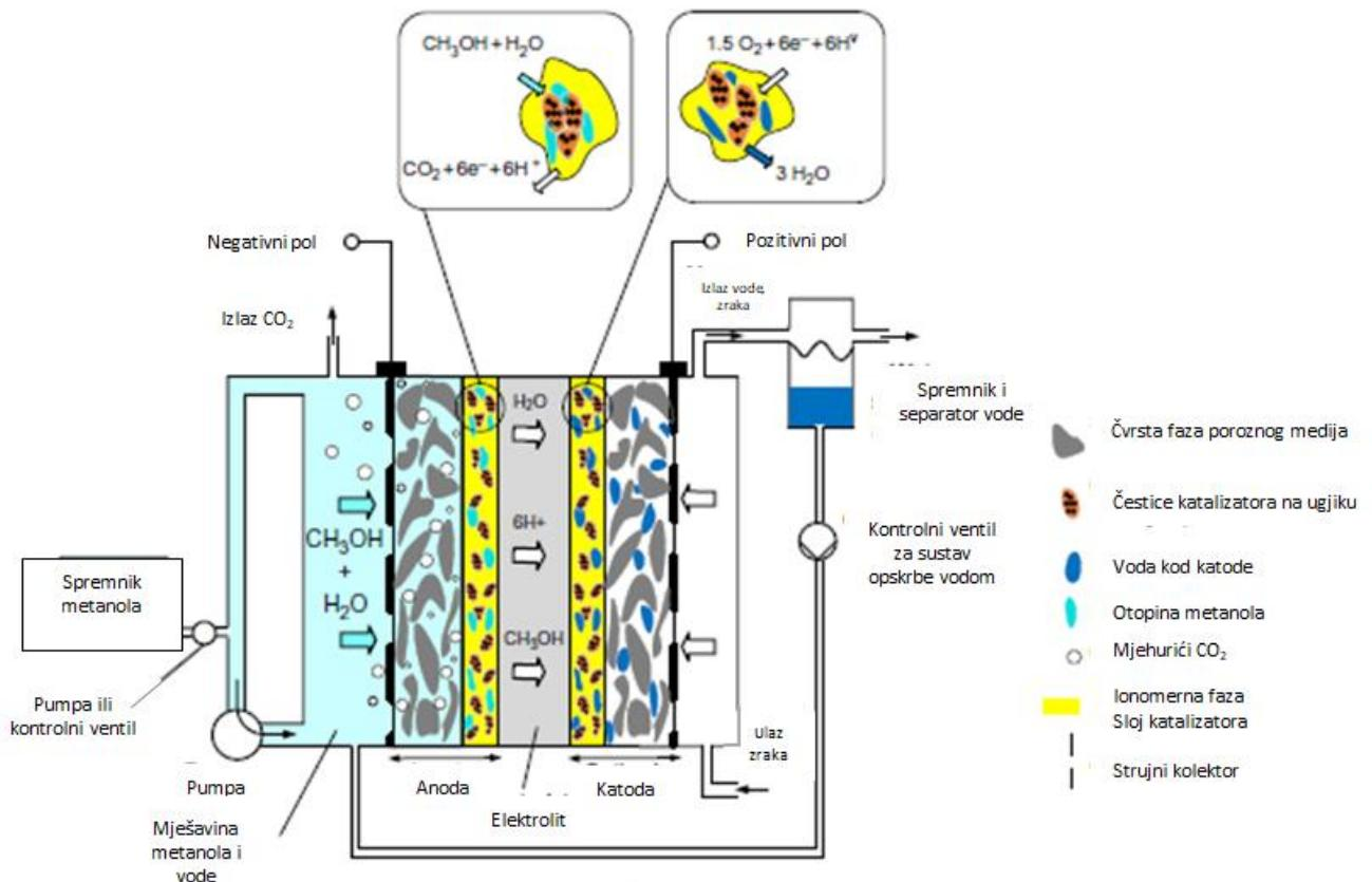
**Slika 4.** Shematski prikaz DMFC gorivog članka<sup>14</sup>
