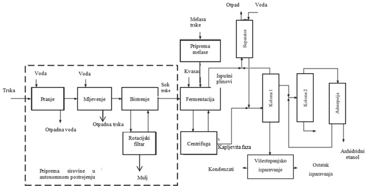
**Slika 6.** Pojednostavljeni dijagram proizvodnje etanola iz šećerne trske<sup>20</sup>
