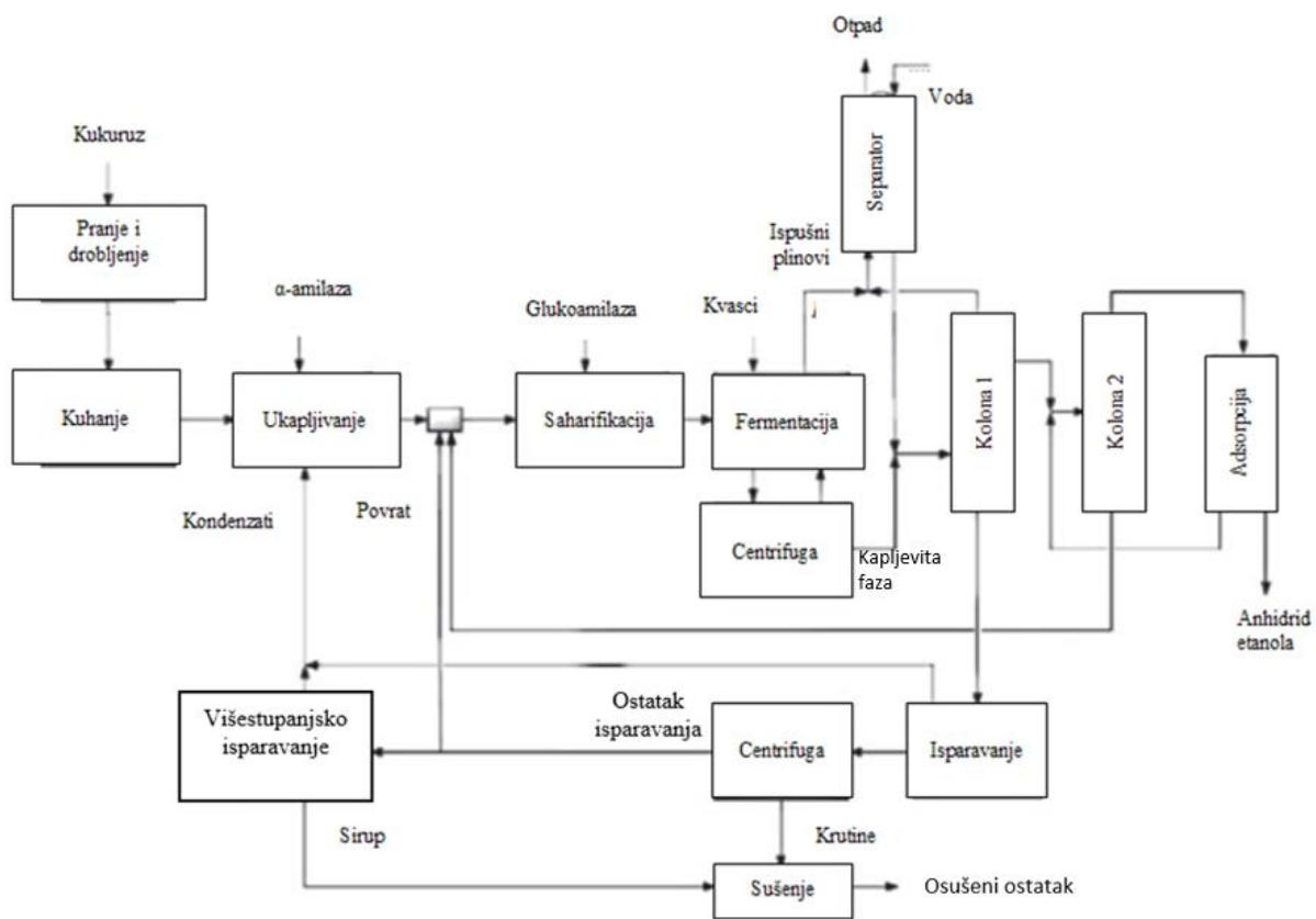
**Slika 7.** Postupak suhog mljevenja zrna kukuruza za proizvodnju etanola hidrolizom i fermentacijom.<sup>20</sup>
