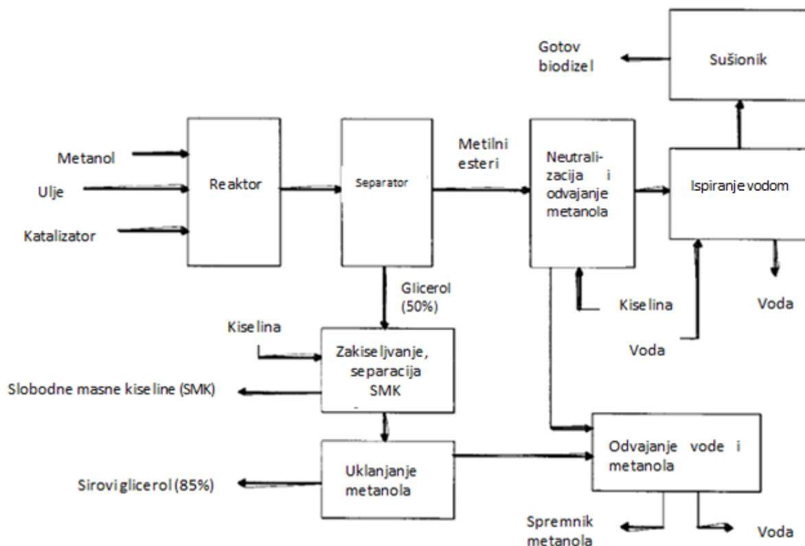
**Slika 11.** Procesna shema proizvodnje biodizela<sup>26</sup>
