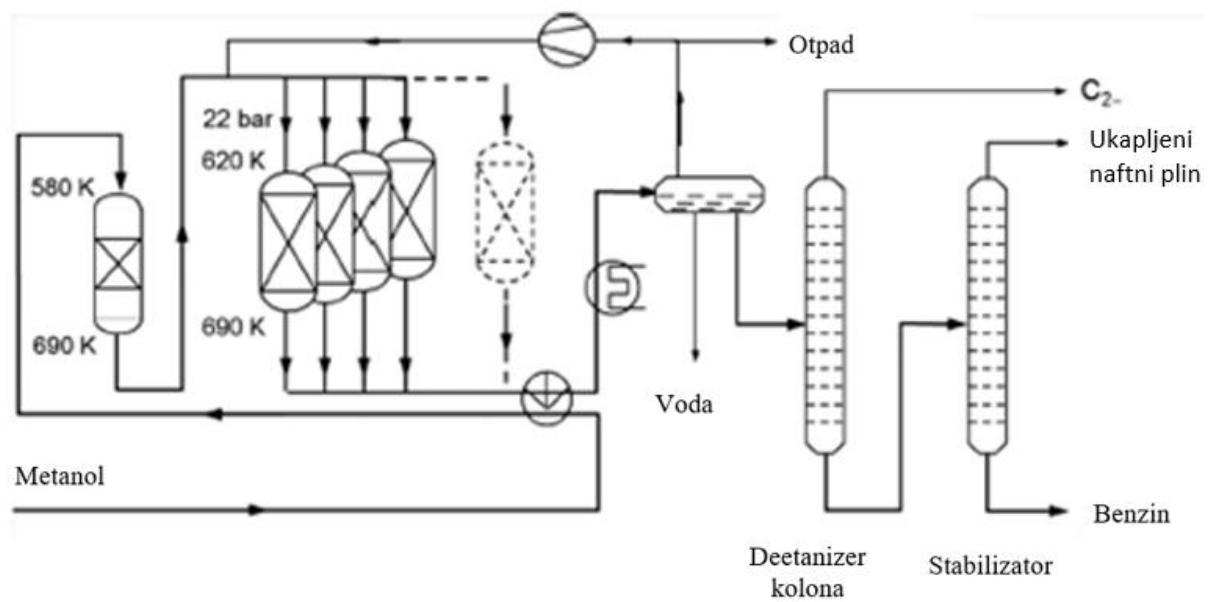
**Slika 5.** Shematski prikaz MTG procesa tvrtke Mobil<sup>11</sup>
