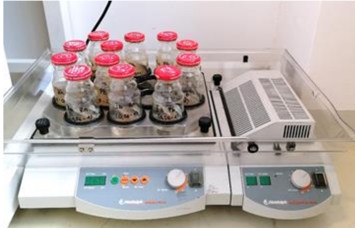
Slika 2.8 Laboratorijska tresilica „Heidolph Unimax 1010“ s uzorcima.
