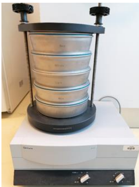
Slika 2.6 Uređaj za prosijavanje „Retsch AS 200 basic“.
