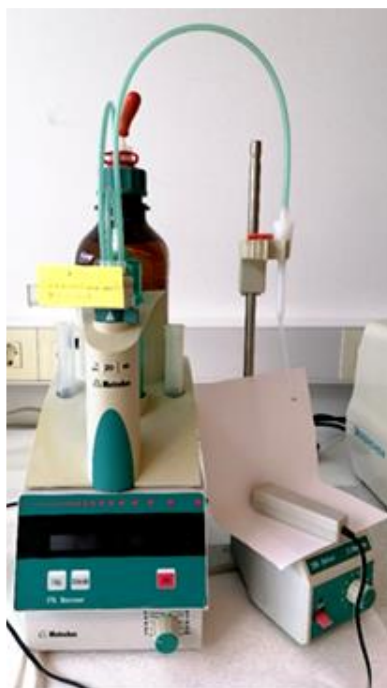
Slika 2.2 Automatski titrator „Metrohm 775 Dosimat“.
