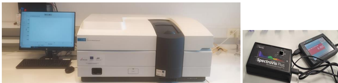
Slika 20. Spektrofotometar Cary 5000 UV–Vis–NIR Agilent Technologies i Vernier UV–VIS Spektrofotometar
