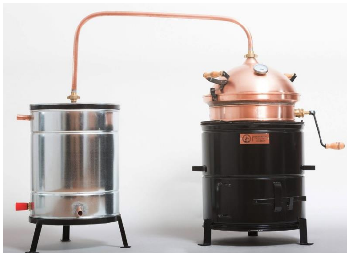
Slika 10. Jednostavni uređaj za destilaciju (29)
