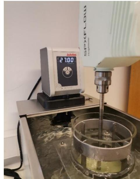
Slika 10. Šaržni reaktor uronjen u termostatiranu kupelj
