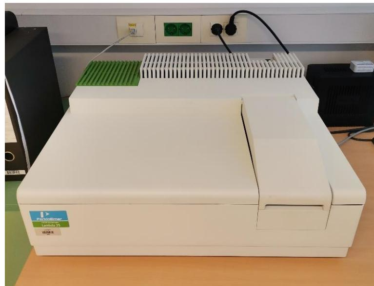
*Slika 12.* Perkin Elmer Lambda 25 UV/Vis spektrofotometar
