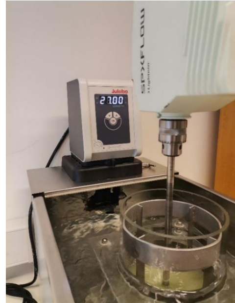
Slika 10. Šaržni reaktor uronjen u termostatiranu kupelj
