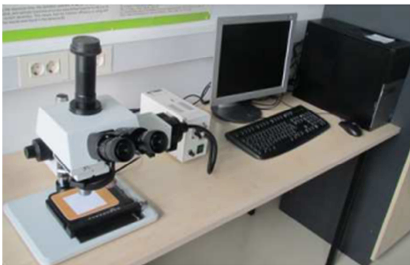
Slika 2.7. Optički mikroskop MXFMS-BD, Ningbo Sunny Instruments Company
