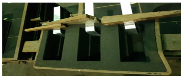
Slika 56 Kalupi za ispitne epruvete. [24]
