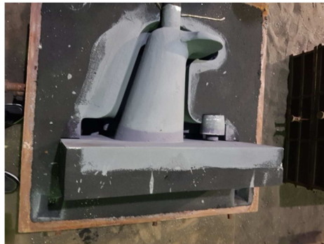
Slika 54. Postavljena centralna jezgra u donji kalup [24]
