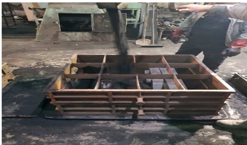
Slika 51. Punjenje kalupa mješavinom za izradu kalupa [24]
