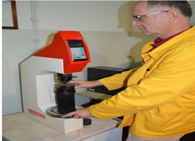
Slika 61. Ispitivanje tvrdoće pomoću tvrdomjera [21]
