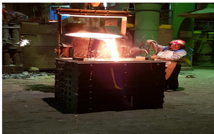
Slika 45. Odljevanje taline za startni blok [24]
