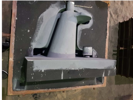
Slika 54. Postavljena centralna jezgra u donji kalup [24]
