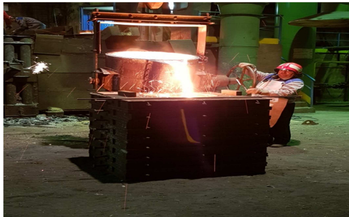
Slika 45. Odljevanje taline za startni blok [24]
