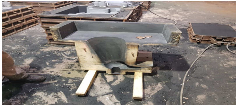
Slika 48. Kalup za izradu centralne jezgre [24]
