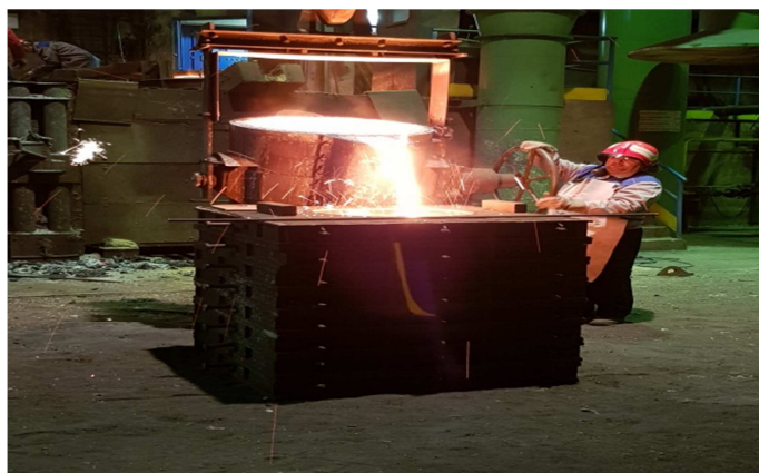
Slika 45. Odljevanje taline za startni blok [24]
