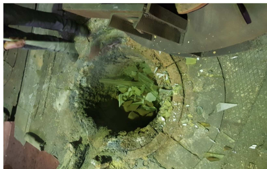
Slika 36. Vrh peći napunjen staklom [24]
