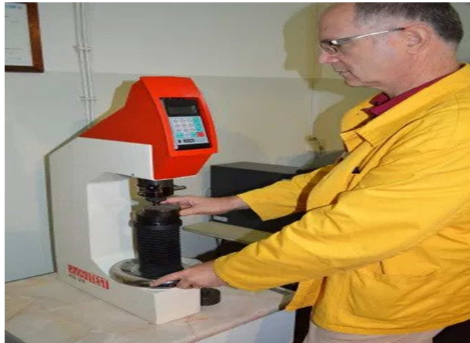
Slika 61. Ispitivanje tvrdoće pomoću tvrdomjera [21]
