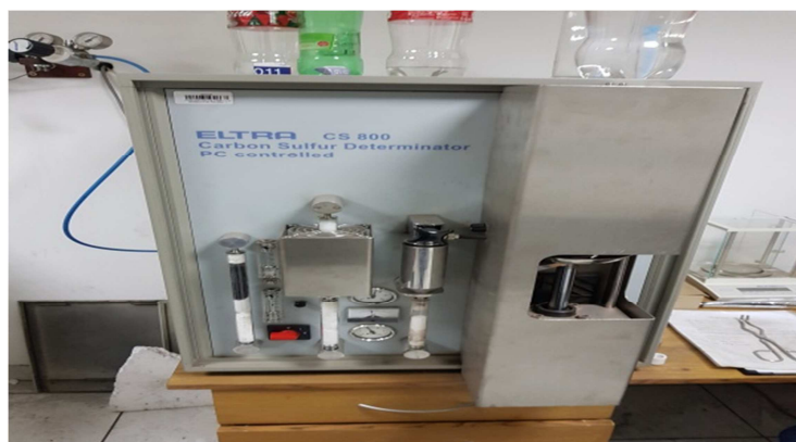
Slika 41. Uređaj za određivanje sadržaja ugljika i sumpora [24]
