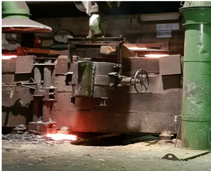
Slika 34. Kotao za proces lijevanja [24]
