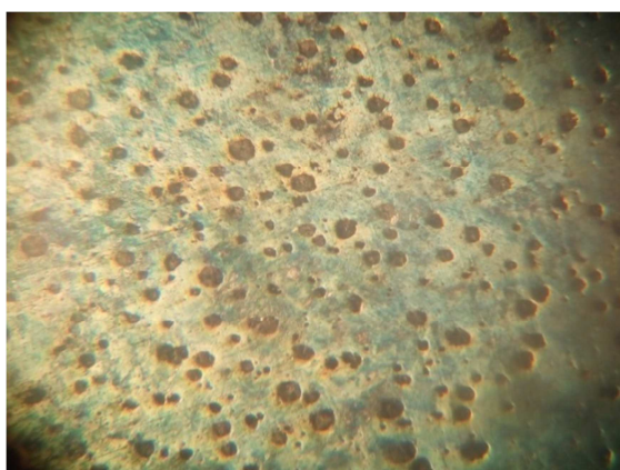
Slika 62. Metalna površina uzorka pod svjetlosnim mikroskopom u nenagriženom stanju uvećana 200 puta [23]
