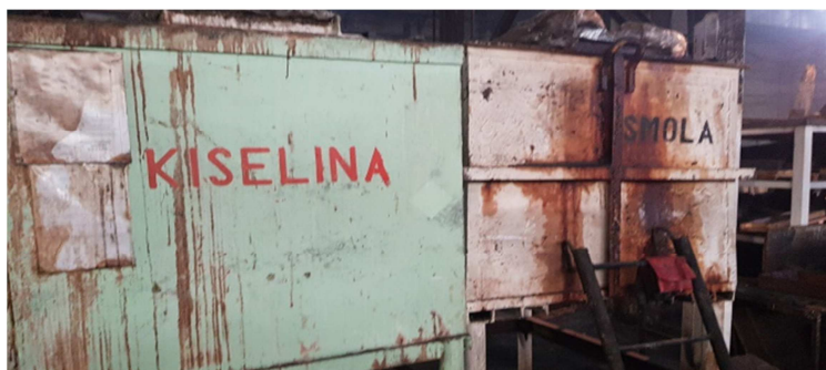
Slika 10. Mješač kiseline, smole i pijeska [24]
