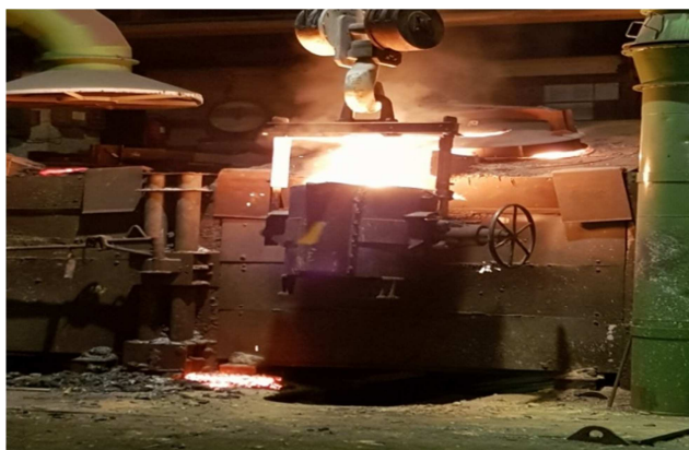
Slika 43. Ulijevanje taline u kotao [24]
