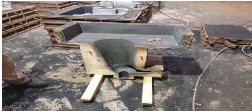
Slika 48. Kalup za izradu centralne jezgre [24]
