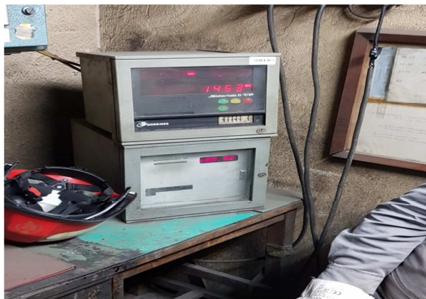
Slika 38. Računalo na kojem se očitava temperaturu [24]
