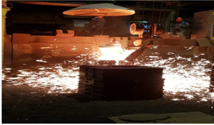
Slika 44. Propuhivanje taline dušikom u svrhu miješanja taline, nodulatora i cjepiva [24]
