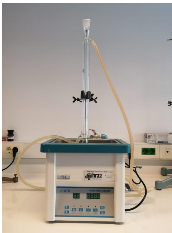
Slika 10. Aparatura za ultrazvučnu ekstrakciju
