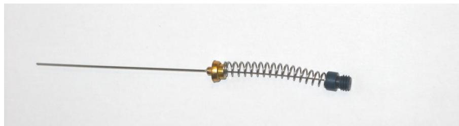
**Slika 7.** Vlakno sa ovojnicom PDMS/DVB (plavo vlakno)
