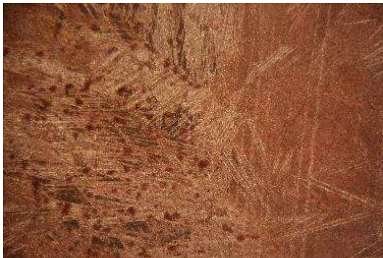
Slika 32. Površina CuAlMnZn elektrode nakon polarizacijskog mjerenja u 0,5 % NaCl otopini uz uvećanje 100×
