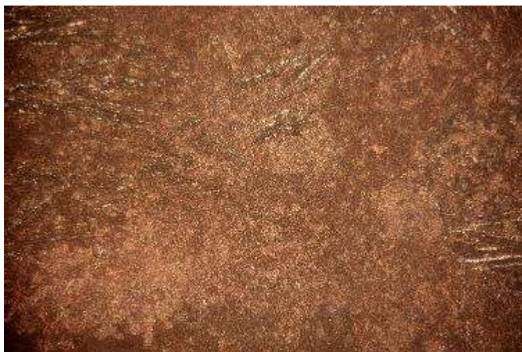
Slika 33. Površina CuAlMnZn elektrode nakon polarizacijskog mjerenja u 0,9 % NaCl otopini uz uvećanje 100×
