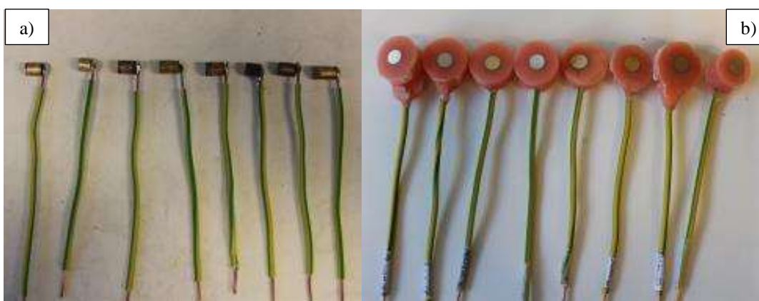
Slika 20. Izrada elektroda za elektrokemijska mjerenja
