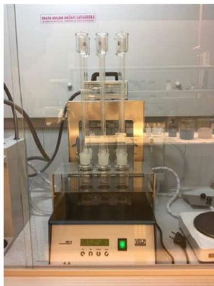
Slika 2.10 Kuhanje smjese u digestoru uz refluks
