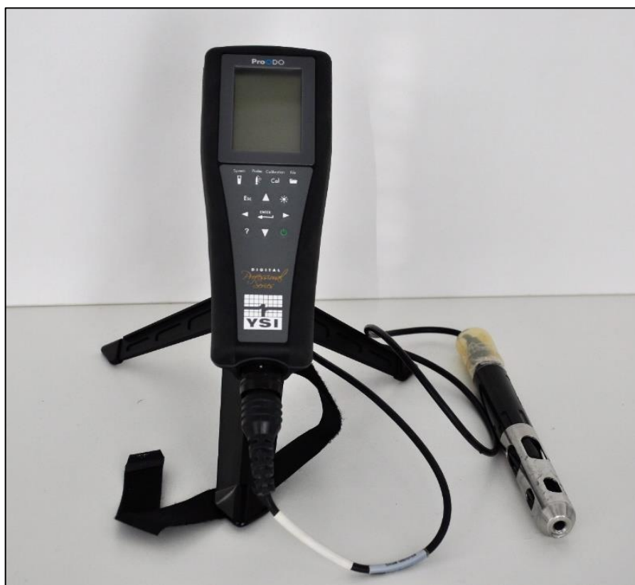
Slika 20. Digitalni oksimetar YSI ProODO s kisikovom elektrodom.
