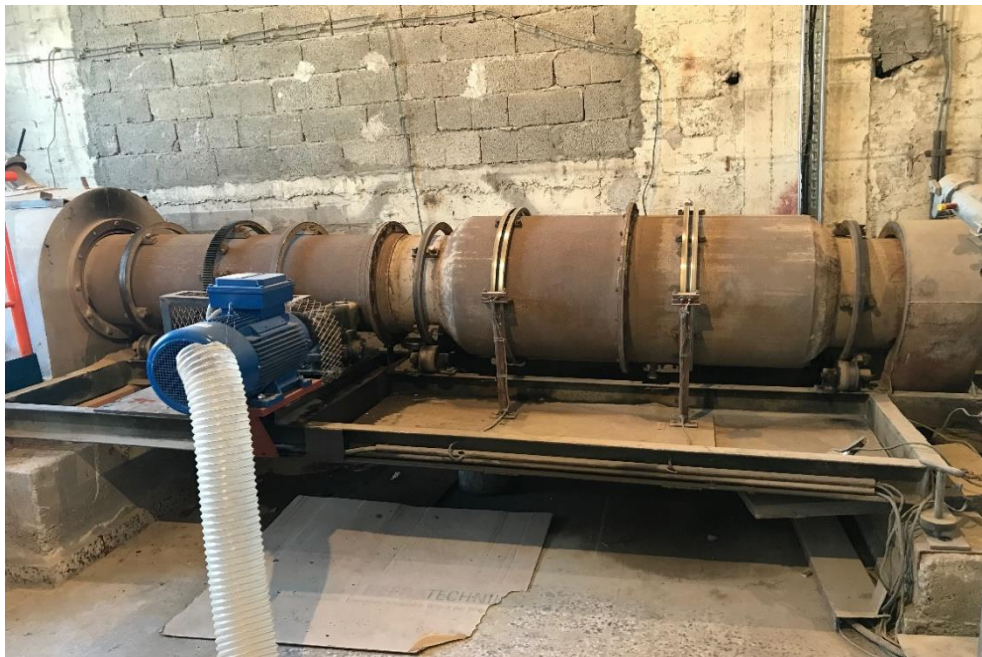
Slika 16. Poluindustrijska rotacijska peć (bočna strana)
