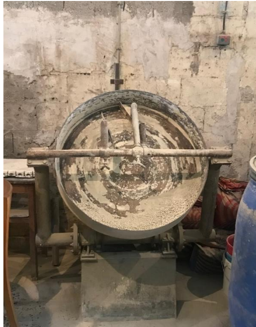
Slika 14. Granulator u poluindustrijskom postrojenju
