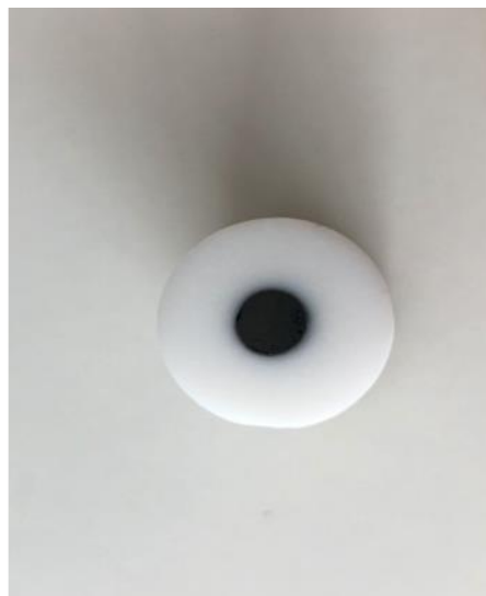
Slika 11. Radna elektroda od staklastog ugljika uklopljena u bazu načinjenu od teflona.
