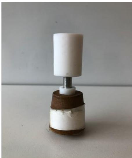
Slika 11. Radna elektroda od staklastog ugljika uklopljena u bazu načinjenu od teflona.
