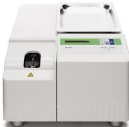
Slika 17. Diferencijalni pretražni kalorimetar DSC 823 e
