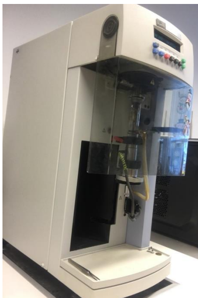
Slika 19. Termogravimetar Pyris 1 TGA
