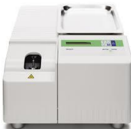
Slika 17. Diferencijalni pretražni kalorimetar DSC 823 e
