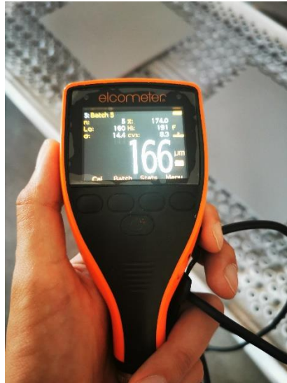
Slika 13. Elcometer 456 mjerac debljine suhog filma
