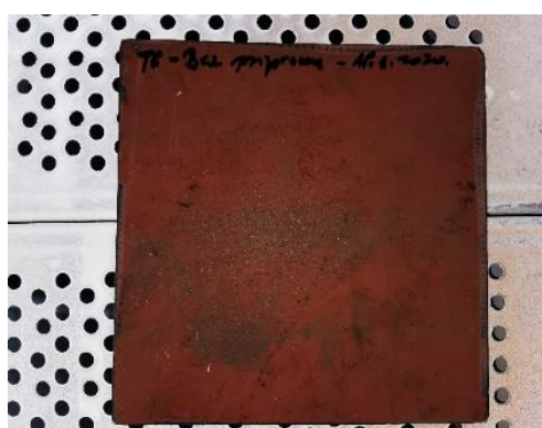
Slika 23. Izgled neobrađene površine čelične ploče 6.
