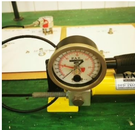
Slika 16. Uređaj PAT model GM04/20kN Adhesion Tester DFD®.
