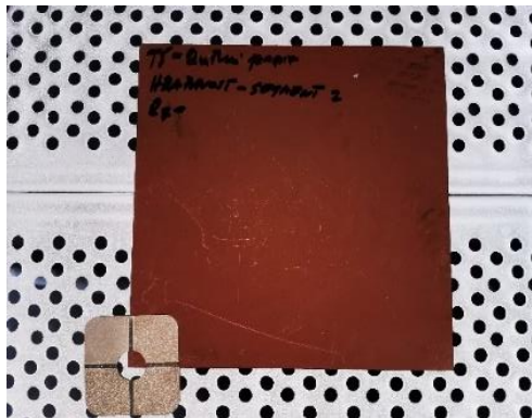
Slika 5. Primjer određivanja hrapavosti površine pomoću komparatora
