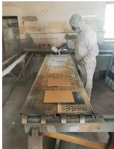
Slika 11. Postupak nanošenja završnog premaza Hemphatane Topcoat 55210/10000.
