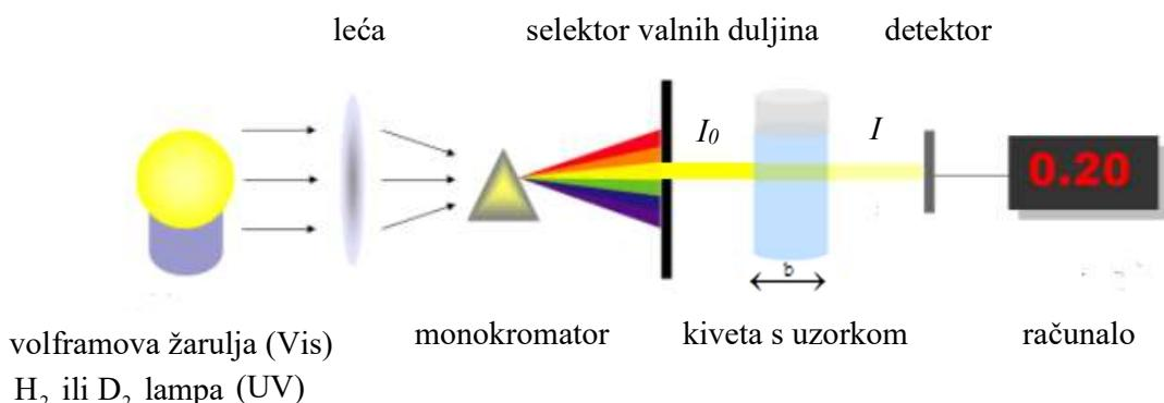
Slika 20. Shema UV/Vis spektrofotometra.
