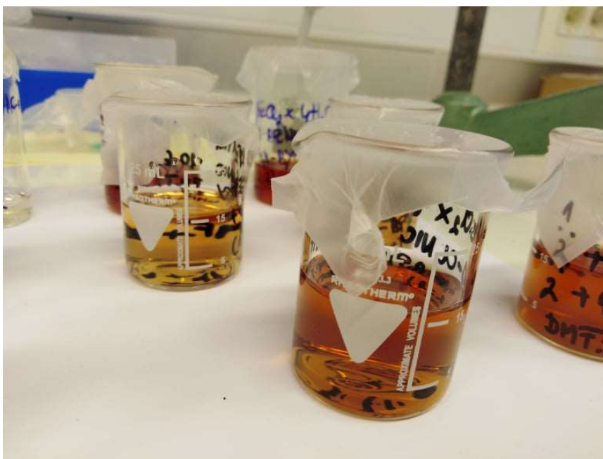
Slika 26. Reakcijske otopine željeza(II) s 2-bromnikotinskom, 5-bromnikotinskom, 6-klornikotinskom kiselinom i 4,4'-bipiridinom u smjesi DMF-a i vode (1:2:2).
