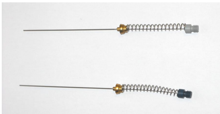
Slika 7. Vlakna s ovojnicama DVB/CAR/PDMS (sivo vlakno) i PDMS/DVB (plavo vlakno) (14)
