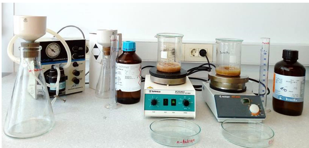
Slika 2.8. Izvedba ekstrakcije ulja iz usitnjenih koštica masline n-heksanom i etanolom
