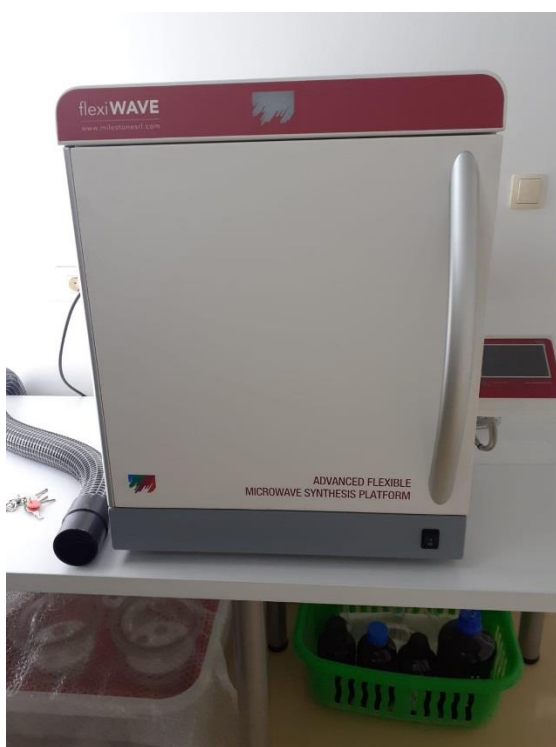
Slika 7. Mikrovalna peć za digestiju
