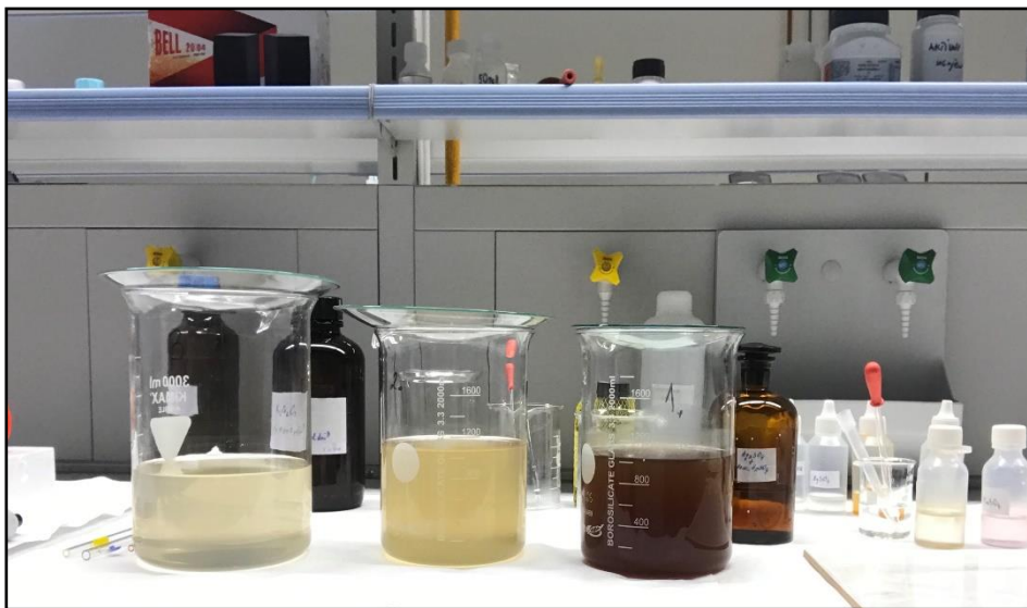
Slika 2.2. Izgled tri dobivena uzorka procjedne vode komine masline obrnutim redosljedom dobivanja
