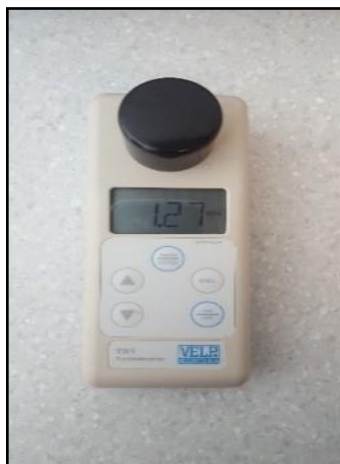
Slika 2.4. Turbidimetar VELP Scientifica
