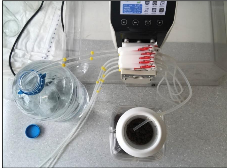
Slika 3.2. Ispiranje suhe komine masline destiliranom vodom pomoću peristaltičke pumpe
