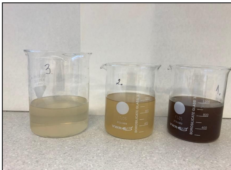
Slika 3.3. Usporedni prikaz dobivenih procjednih voda suhe komine masline tijekom tri dana
