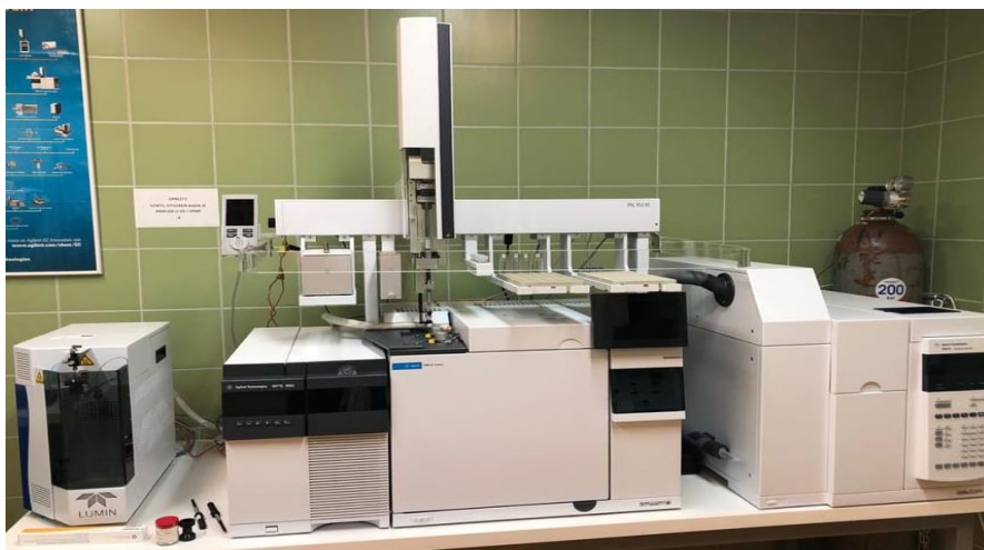
Slika 15. Vezani sustav plinska kromatografija i spektrometrija masa (50)
