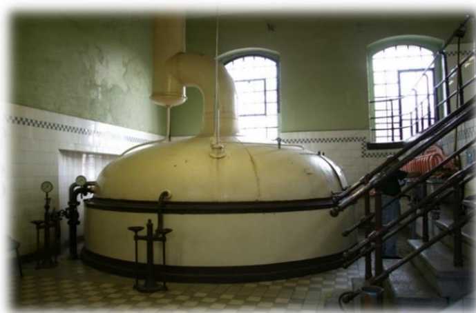
Slika 11. Koto za kuhanje sladovine. 23
