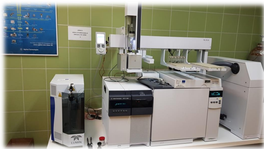
Slika 18. Vezani sustav plinska kromatografija-spektrometrija masa (GC-MS). 38
