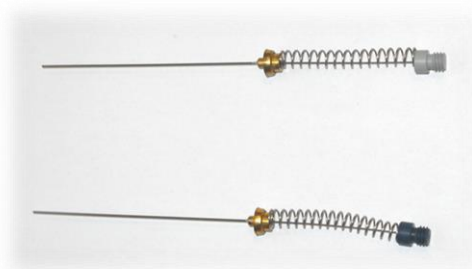
Slika 17. Vlakna s ovojnicama DVB/CAR/PDMS (sivo vlakno) i PDMS/DVB (plavo vlakno). 38
