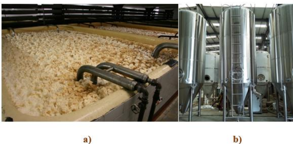
Slika 12. Fermentacija piva: a) otvoreni betonski bazen 23 ; b) cilindrično-konusni spremnik. 24
