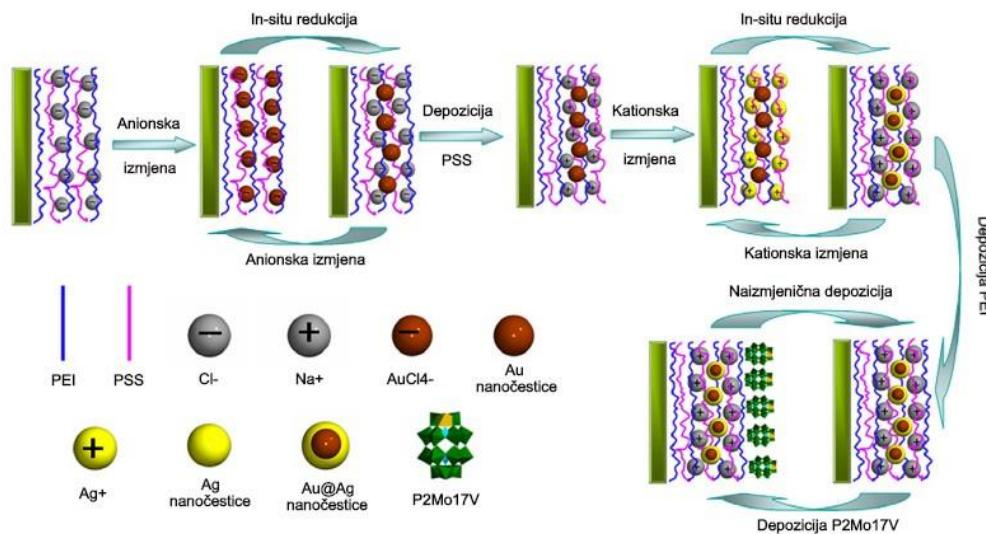
**Slika 8** - Shematski prikaz konstrukcije LbL filma sastavljenog od Au@2Ag nanočestica jezgrene ljske i P<sub>2</sub>Mo<sub>17</sub>V. [42]
