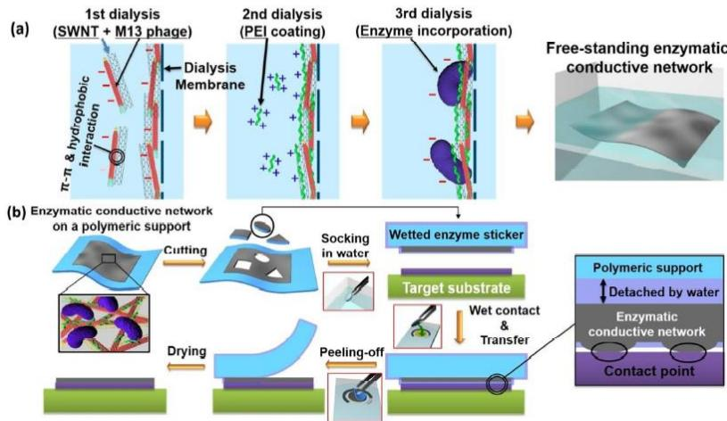
**Slika 9** - Shematski prikaz priprave enzimske naljepnice: a) konstrukcija nano-mrežnog provodljivog enzimskog filma, b) struktura enzimske naljepnice i princip rada wet-transfer-print metode. [49]
