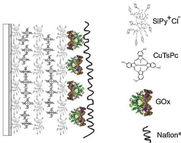
Slika 7 - Shematski prikaz priprave biosenzora za određivanje glukoze. [41]
