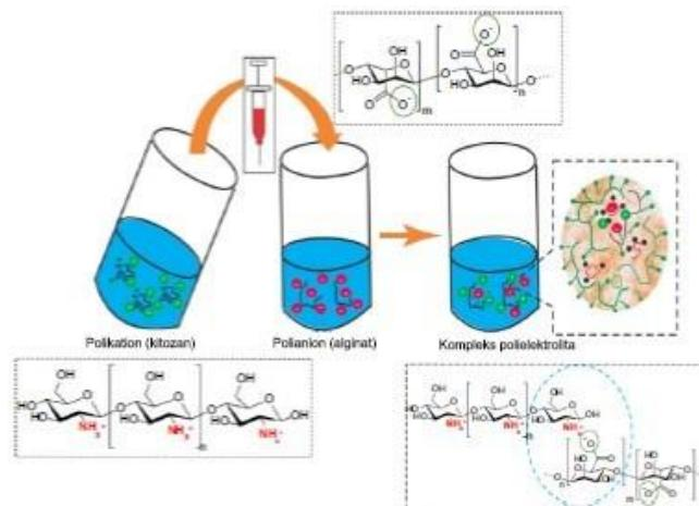
**Slika 1** - Shematski prikaz formiranja kompleksa polielektrolita (PEC) [11]
