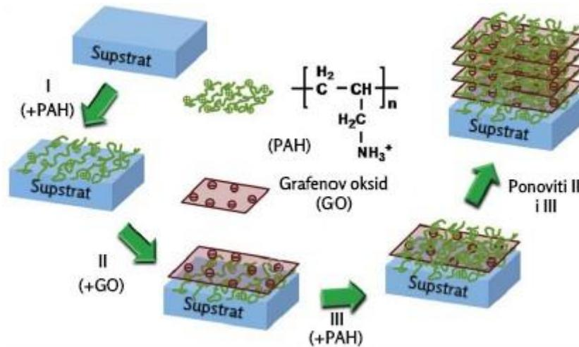
*Slika 3* - Shematski prikaz nastajanja  $[PAH\text{-}GO]_n/GCE$  senzora za određivanje bakrovih (II) iona. [20]
