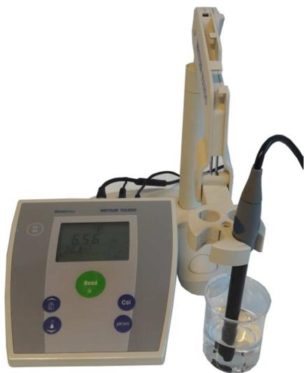
**Slika 2.1.** pH metar Mettler Toledo.
