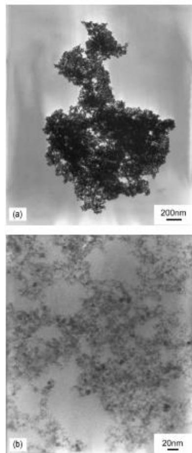
**Slika 4.** TEM fotografije a) Fe<sub>3</sub>O<sub>4</sub> nanočestice pripravljenih metodom koprecipitacije bez prisutnosti PAA oligomera i b) ferrofluid pripravljen metodom koprecipitacije uz prisustvo PAA oligomera.<sup>11</sup>
