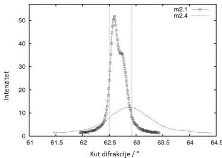
**Slika 9.** Difraktogram X-zraka magnetnih nanočestica željezova oksida za 2 različita uzorka, m2.1 i m2.4.<sup>17</sup>
