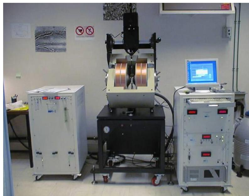
**Slika 12.** Magnetometar vibrirajućeg uzorka.<sup>20</sup>
