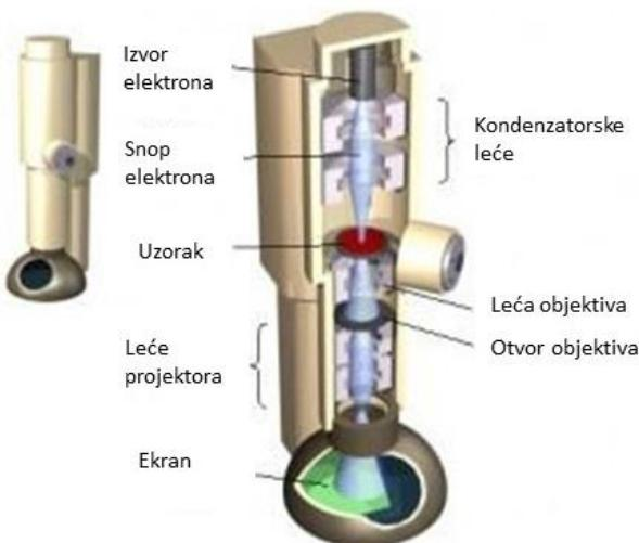
**Slika 6.** JEOL 1010 transmisijski elektronski mikroskop.<sup>14</sup>
