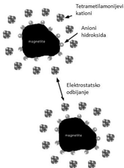
**Slika 2.** Idealizirana ilustracija vodenog ferrofluida stabiliziranog tetrametilamonijevim hidroksidom kao surfaktantom. Surfaktant okružuje čestice magnetita anionima hidroksida koji privlače tetrametilamonijeve katione formirajući difuznu ljušku oko svake čestice uzrokujući odbijanje čestica i stabilnost koloida.<sup>1</sup>
