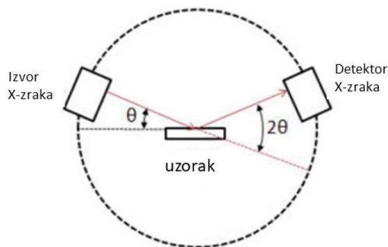
**Slika 10.** Shematski prikaz dijelova difraktometra.<sup>18</sup>
