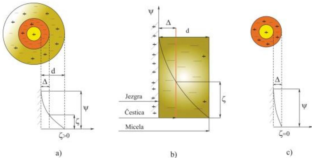
**Slika 17.** Nastajanje elektrokinetičkog potencijala u adsorbiranom sloju: a) micela, b) Zeta potencijal, c) izoelektrična točka.<sup>24</sup>
