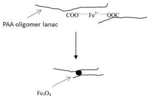
**Slika 5.** Mehanizam sinteze ferrofluida: nukleacija nanočestica.<sup>11</sup>
