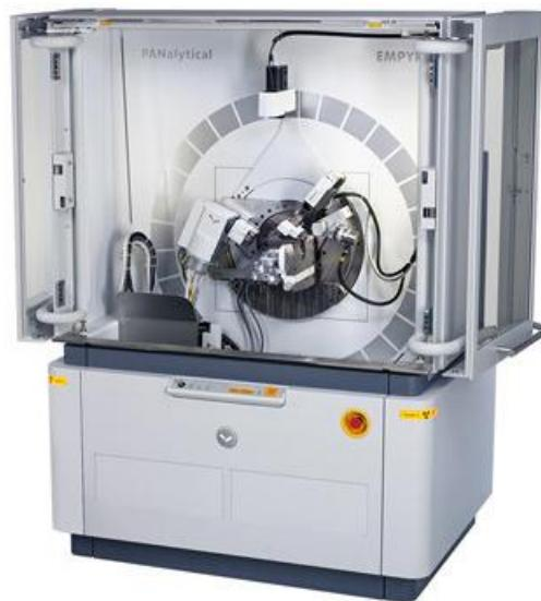
**Slika 11.** Empyrean difraktometar X-zraka.<sup>19</sup>
