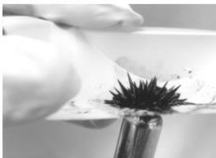
**Slika 3.** Bočni prikaz stvaranja bodlji ferrofluida u prisutnosti snažnog magneta postavljenog ispod lađice.<sup>1</sup>
