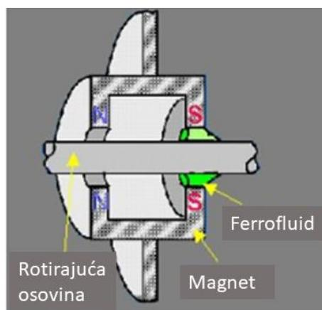
Slika 18. Rotirajuća brtva osovine.<sup>6</sup>
