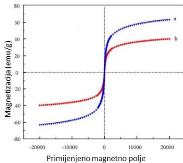
**Slika 13.** Krivulje  $\text{Fe}_3\text{O}_4$  nanočestica (a) i  $\text{Fe}_3\text{O}_4/\text{SiO}_2$  nanočestica (b) dobivene magnetometrijom vibrirajućeg uzorka.<sup>2</sup>
