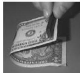
**Slika 20.** Magnetske tinte tiskaju se na novac u identifikacijske svrhe. Kada se snažni magnet prinese novčanici, novčanica se privuče na magnet.<sup>1</sup>
