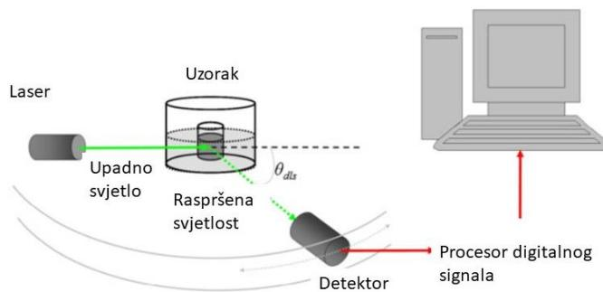
**Slika 14.** Shematski prikaz aparature za dinamičko raspršivanje svjetla.<sup>22</sup>
