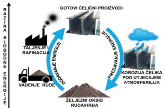
Slika 7. Nastajanje korozije u prirodi 23
