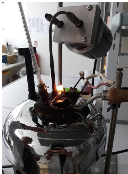
Slika 10. Uređaj za određivanje plamišta po Pensky- Martensu
