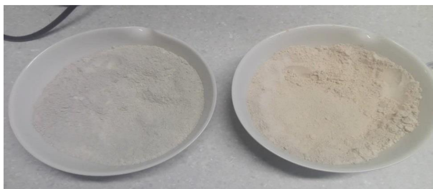
Slika 9. Zeolit klinoptilolit veličine čestica 10μm (lijevo) i 50μm (desno)
