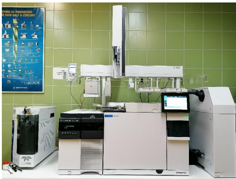
Slika 34. Vezani sustav plinska kromatografija-spektrometrija masa (GC-MS)
