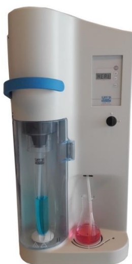
Slika 2.6. Uređaj za destilaciju uzorka.
