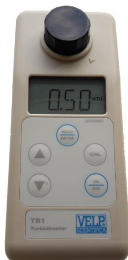
Slika 2.3. Turbidimetar Velp Scientifica.
