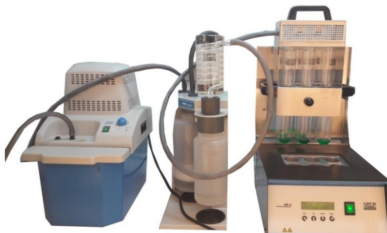
Slika 2.5. Uređaj za digestiju uzorka.
