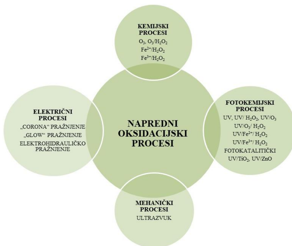
Slika 1.7. Podjela naprednih oksidacijskih procesa 22
