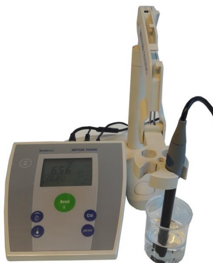
Slika 2.1. pH-metar Mettler Toledo.
