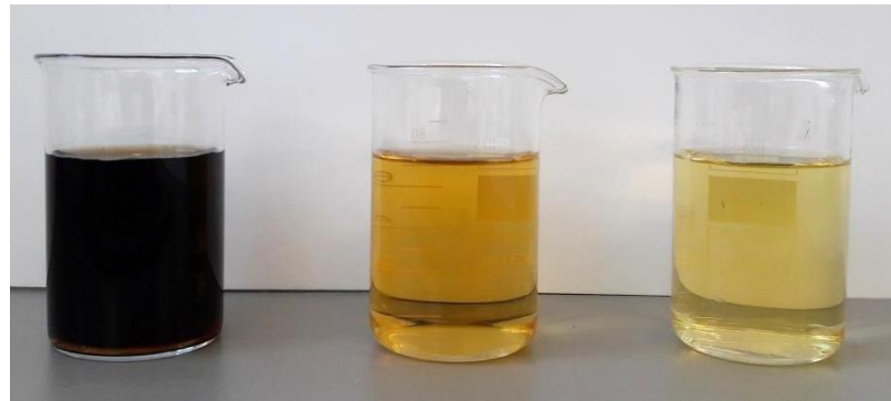
Slika 4.2. Boja a) izvornog uzorka procjedne vode, b) nakon kemijskog taloženja i c) nakon kemijskog taloženja i aeracije.
