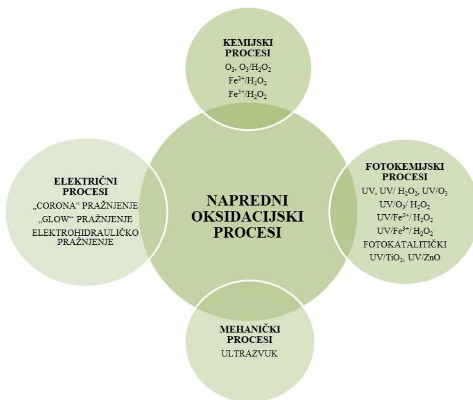
Slika 1.7. Podjela naprednih oksidacijskih procesa 22
