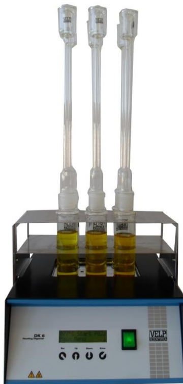
Slika 2.4. Uređaj za određivanje KPK bikromatnom metodom.
