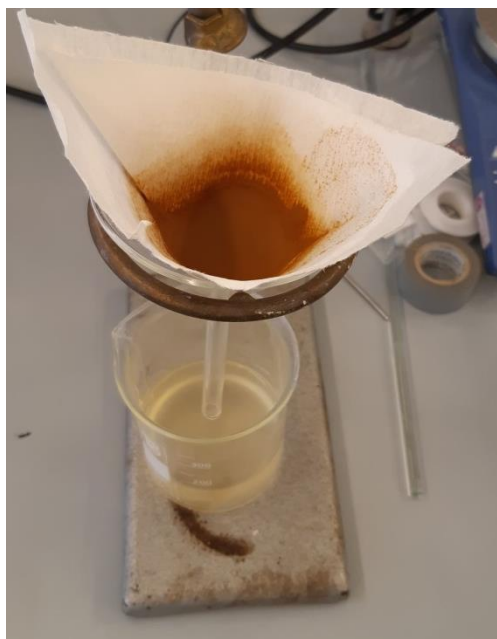
Slika 12. Filtriranje smjese SA, MKM i acetona
