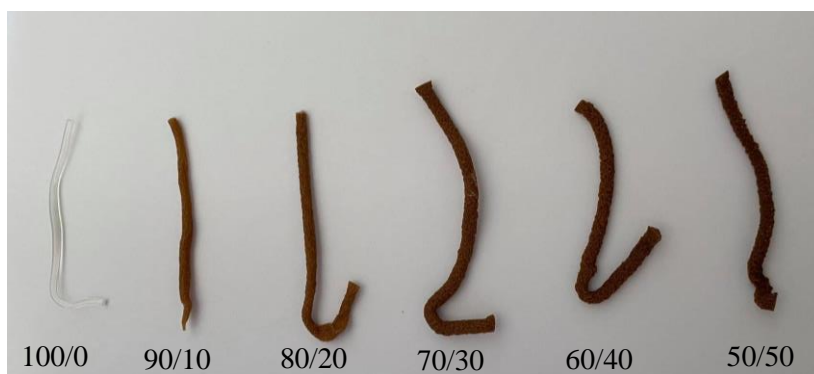
Slika 17. Ekstrudirani kompoziti PLA/mMKM
