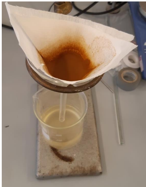
Slika 12. Filtriranje smjese SA, MKM i acetona
