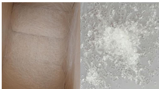
Slika 16. Ekstrudirane i usitnjene niti PLA
