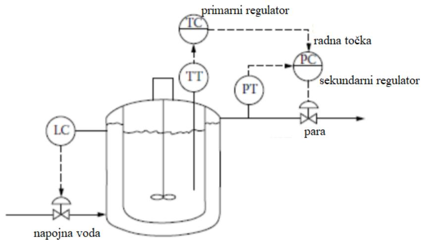
Slika 14. Vođenje temperature pomoću vruće vode u plaštu šaržnog reaktora<sup>3</sup>
