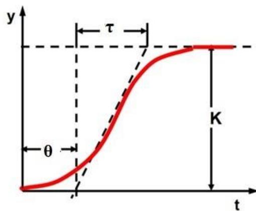
Slika 25. Određivanje parametara procesa iz kojih se mogu odrediti postavke regulatora<sup>18</sup>
