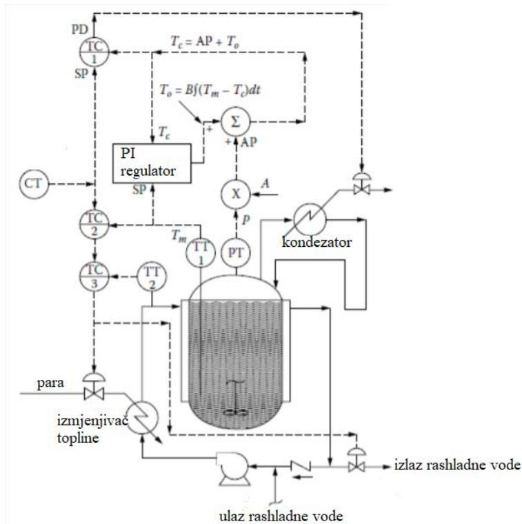
Slika 13. Vođenje temperature kompenzacijom tlaka u šaržnom reaktoru<sup>3</sup>
