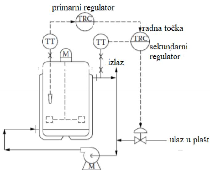
Slika 11. Kaskadno vođenje temperature u šaržnom reaktoru<sup>3</sup>
