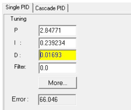
Slika 36. Primjer prikaza rezultata određivanja parametara regulatora
