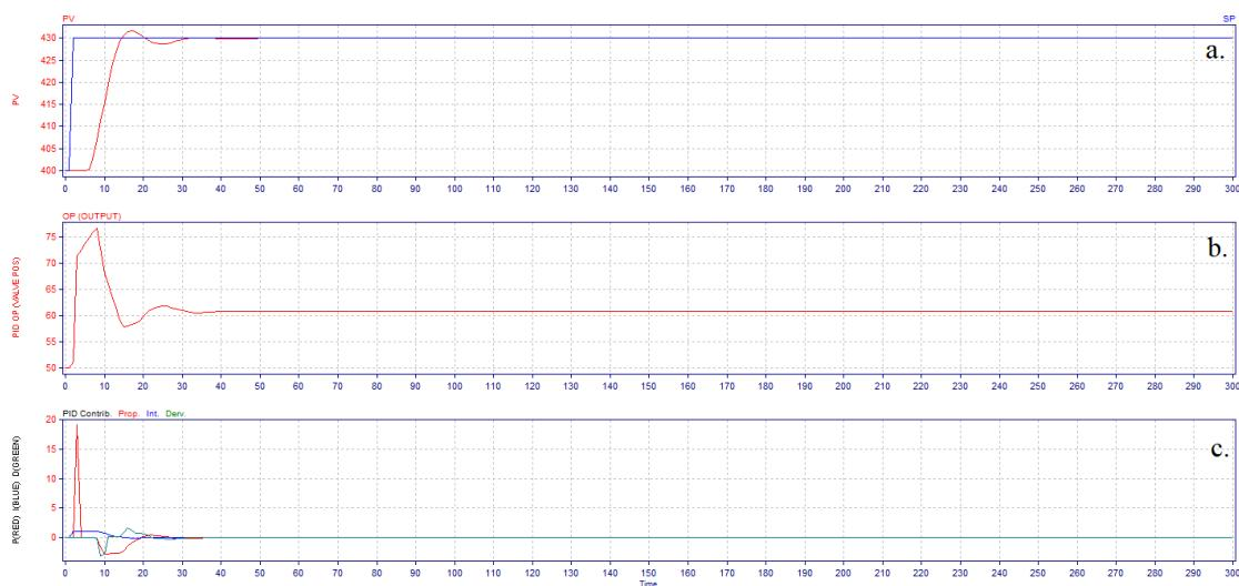
Slika 50. Ovisnost *PV* o vremenu (a.), ovisnost *OP* o vremenu (b.) i ovisnost vrijednosti parametara regulatora o vremenu (c.) pri ugađanju regulatora s *Pitops IAE* metodom
