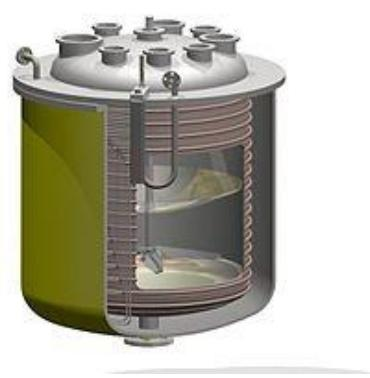
Slika 7. Šaržni reaktor s plaštom s konstantnim protokom<sup>10</sup>
