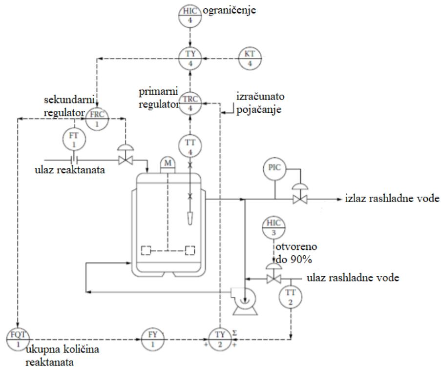
Slika 15. Vođenje temperature u šaržnom reaktoru brzinom dodavanja reaktanata<sup>3</sup>
