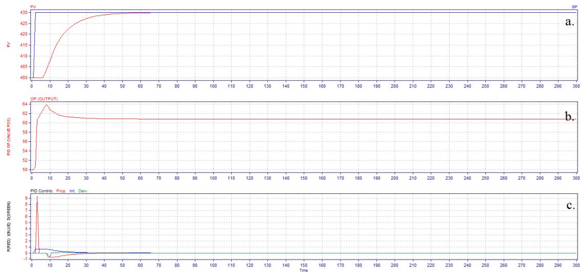
Slika 53. Ovisnost  $PV$  o vremenu (a.), ovisnost  $OP$  o vremenu (b.) i ovisnost vrijednosti parametara regulatora o vremenu (c.) pri ugađanju regulatora s *Pitops RO* metodom
