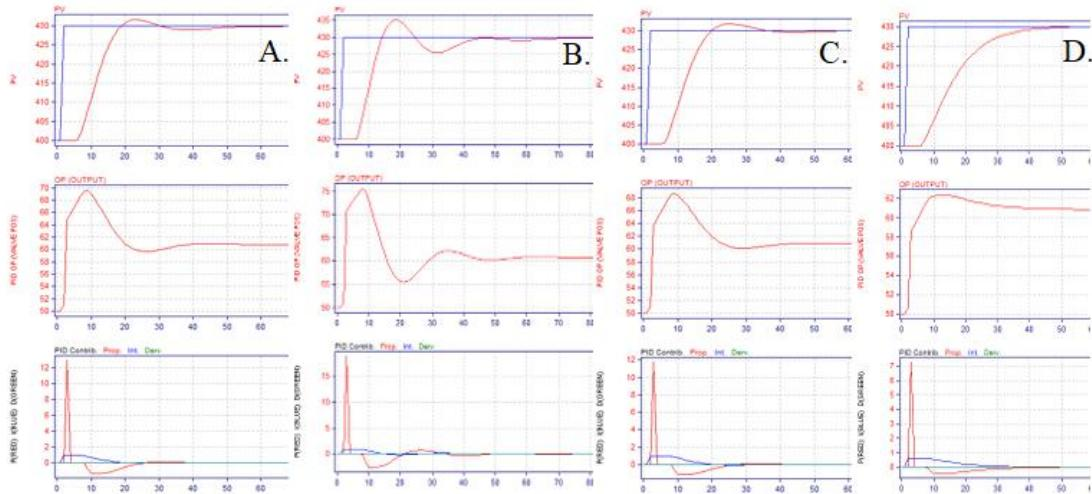
Slika 54. Odzivi procesa kod *Pitops* metoda s isključenim derivacijskim djelovanjem
