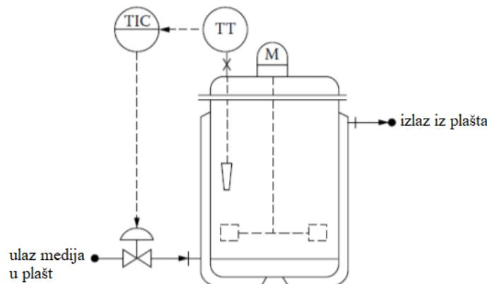
Slika 9. Najjednostavniji oblik vođenja temperature u šaržnom reaktoru<sup>3</sup>
