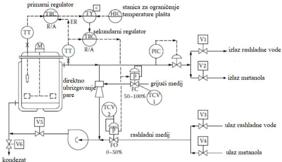
Slika 12. Kaskadno i podijeljeno vođenje temperature u šaržnom reaktoru<sup>3</sup>
