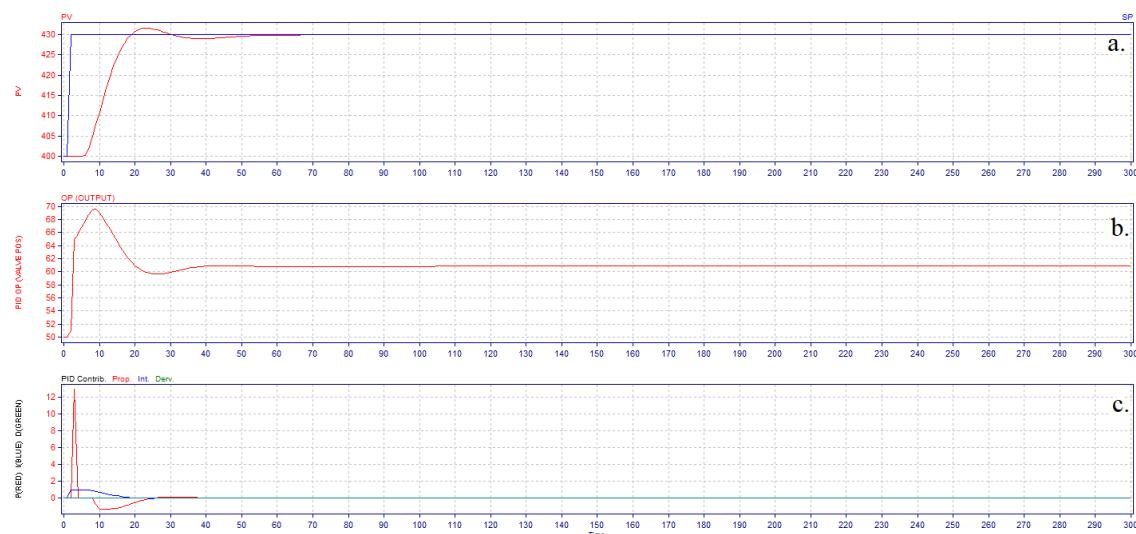
Slika 46. Ovisnost *PV* o vremenu (a.), ovisnost *OP* o vremenu (b.) i ovisnost vrijednosti parametara regulatora o vremenu (c.) pri ugađanju regulatora s *Pitops* IAE metodom
