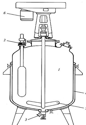
Slika 3. Presjek šaržnog reaktora (1 - procesni prostor, 2 - ulaz reakcijske smjese, 3 - izlaz produkta, 4 - plašt, 5 - miješalica. 6 - motor)<sup>6</sup>
