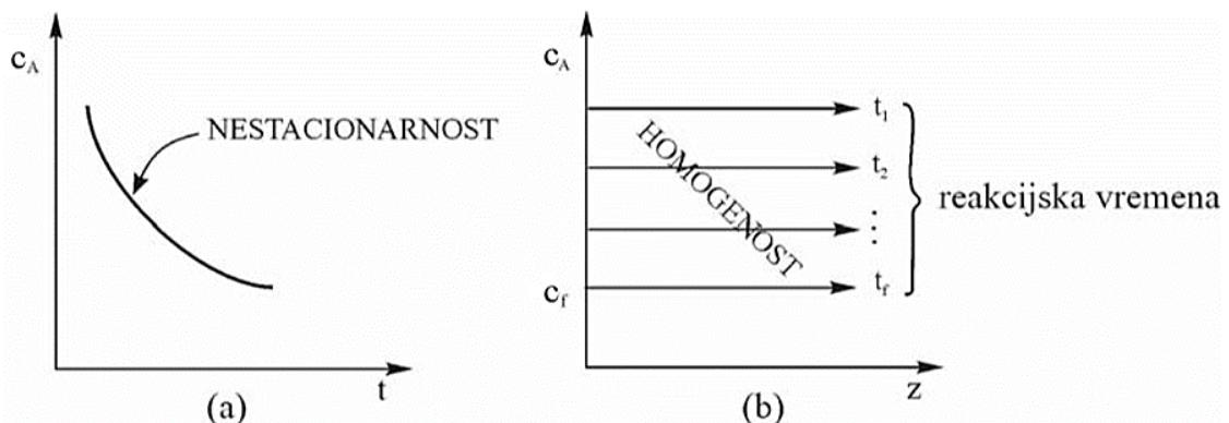
Slika 4. Karakteristike idealnog šaržnog reaktora<sup>5</sup>
