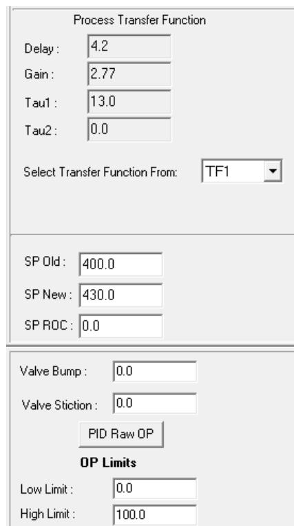
Slika 34. Primjer postavki koje prethode određivanju parametara regulatora
