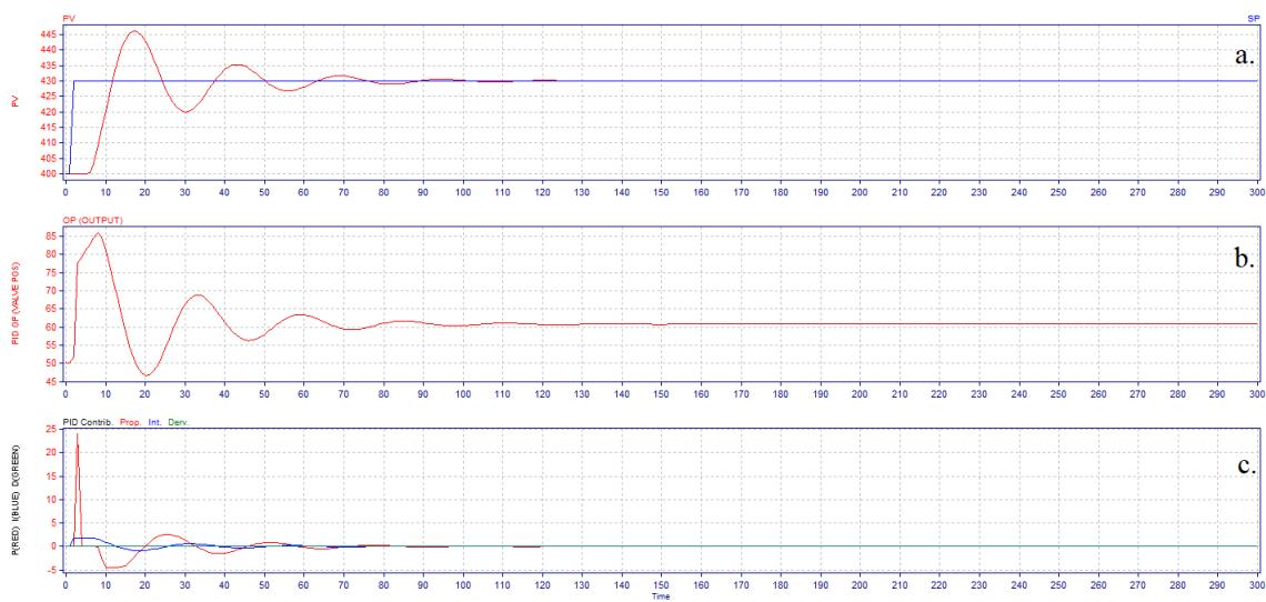
Slika 43. Ovisnost  $PV$  o vremenu (a.), ovisnost  $OP$  o vremenu (b.) i ovisnost vrijednosti parametara regulatora o vremenu (c.) pri PI regulaciji s *Ziegler-Nichols* metodom
