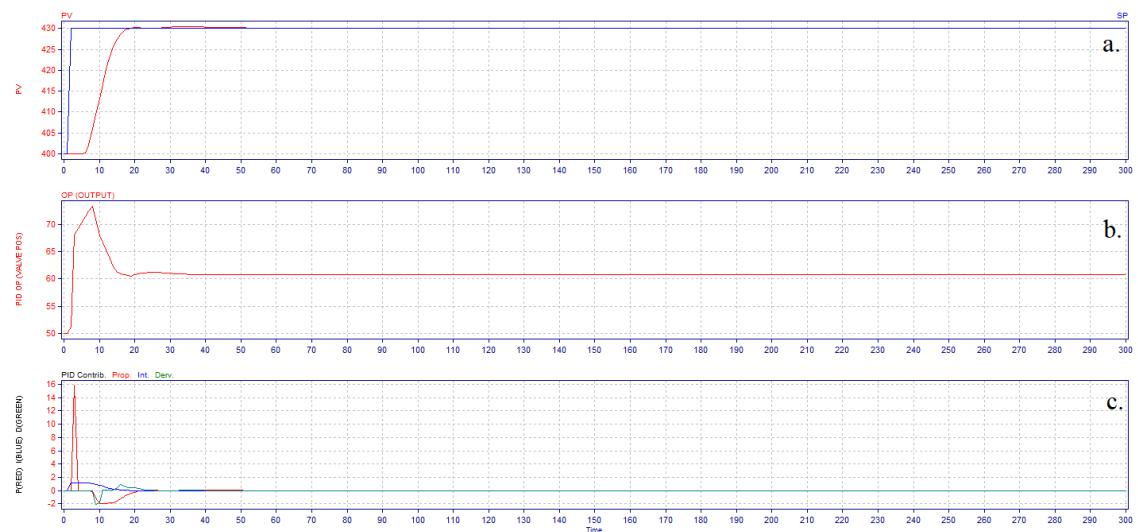
Slika 52. Ovisnost  $PV$  o vremenu (a.), ovisnost  $OP$  o vremenu (b.) ovisnost vrijednosti parametara regulatora o vremenu (c.) pri ugadanju regulatora s *Pitops ITAE* metodom
