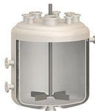
Slika 5. Šaržni reaktor s plaštom<sup>8</sup>
