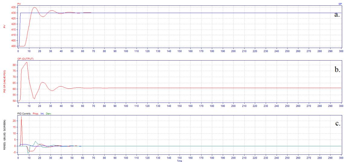
Slika 51. Ovisnost  $PV$  o vremenu (a.), ovisnost  $OP$  o vremenu (b.) ovisnost vrijednosti parametara regulatora o vremenu (c.) pri ugadanju regulatora s *Pitops ISE* metodom
