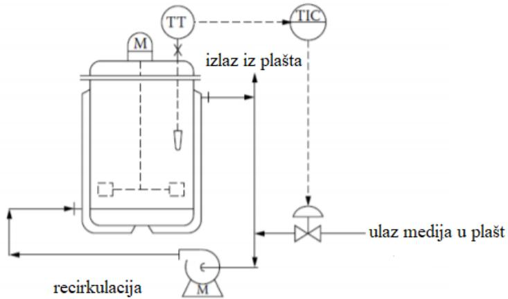
Slika 10. Vođenje temperature s recirkulacijom u šaržnom reaktoru<sup>3</sup>
