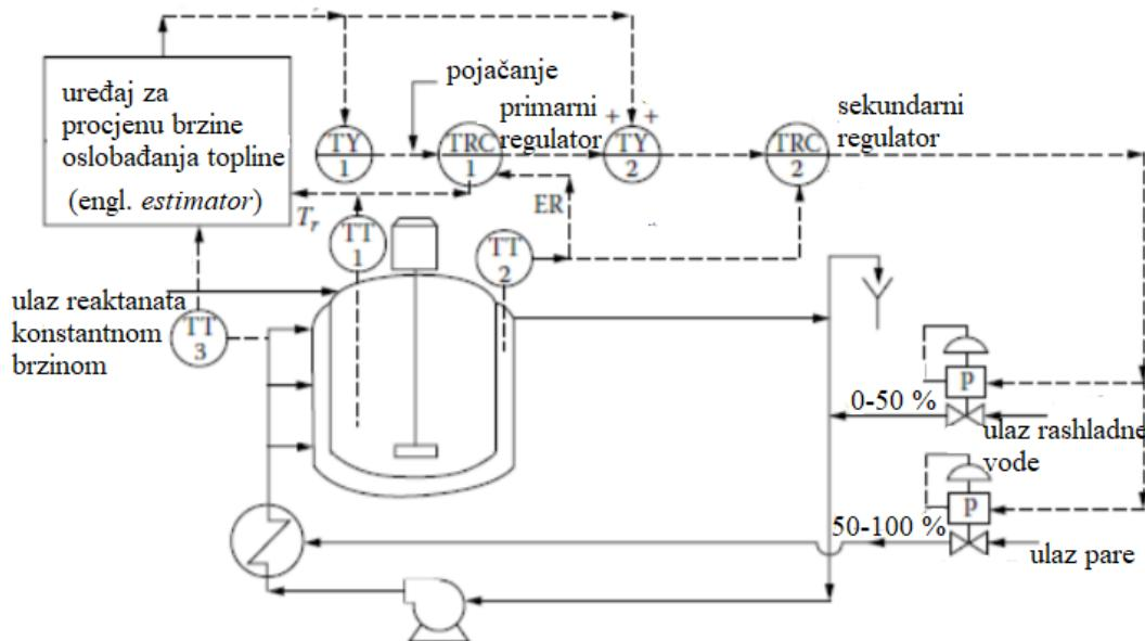
Slika 16. Vođenje temperature u šaržnom reaktoru na temelju modela procesa<sup>3</sup>
