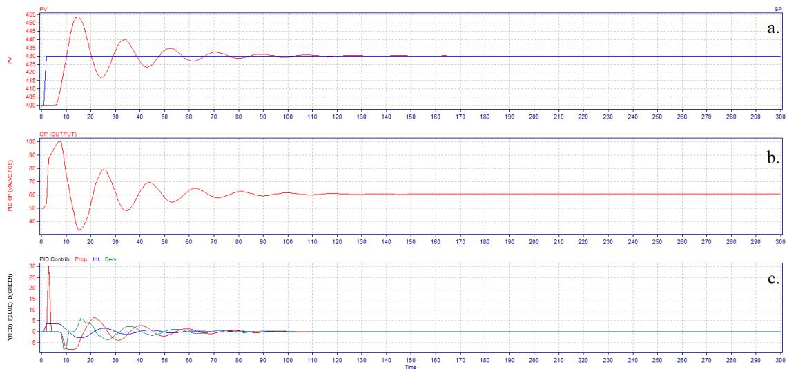
Slika 44. Ovisnost  $PV$  o vremenu (a.), ovisnost  $OP$  o vremenu (b.) i ovisnost vrijednosti parametara regulatora o vremenu (c.) pri PID regulaciji s *Ziegler-Nichols* metodom
