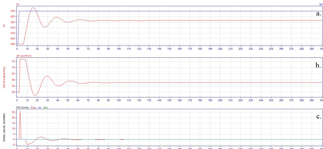
Slika 42. Ovisnost PV o vremenu (a.), ovisnost OP o vremenu (b.) i ovisnost vrijednosti parametara regulatora o vremenu (c.) pri P regulaciji s *Ziegler-Nichols* metodom
