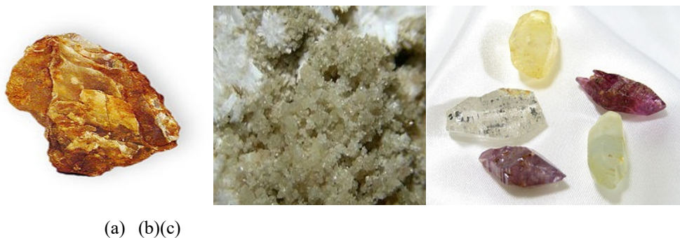
Slika 1.4. Kristalni oblici aluminijeva oksida:(a) bajerit, (b) bemit i (c) korund.
