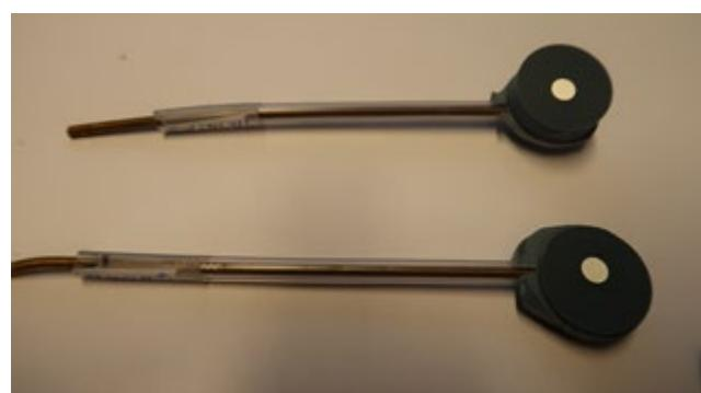
Slika 2.3. Elektrode od Al na kojima su provedena mjerena.
