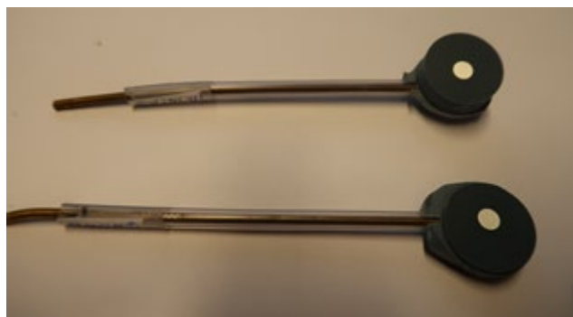
Slika 2.3. Elektrode od Al na kojima su provedena mjerenja.
