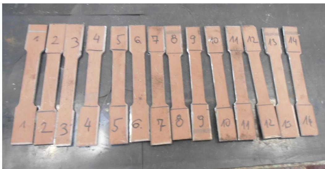
**Slika 15.** Epruvete za mehanička ispitivanja
