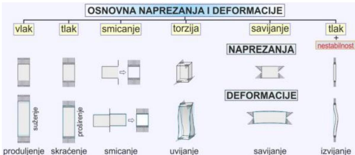
Slika 7. Vrste deformacija i naprezanja<sup>13</sup>
