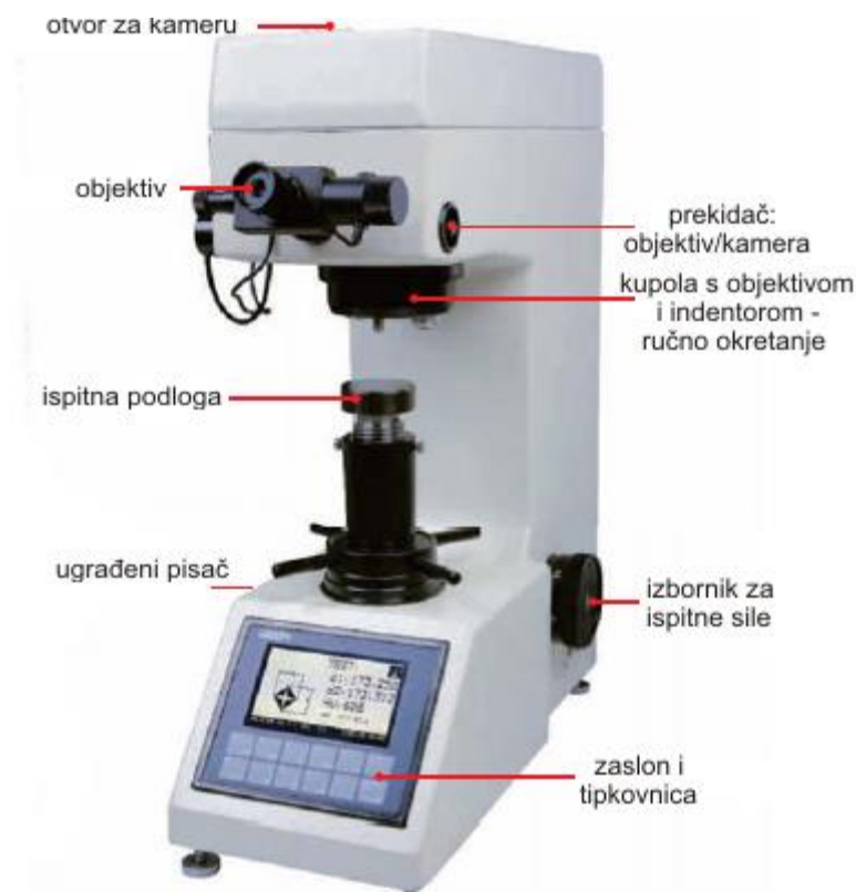
Slika 11. Uređaj za ispitivanje tvrdoće tzv. tvrdomjer 16
