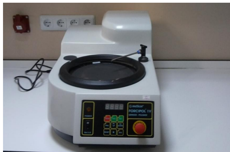
Slika 14. Uređaj za brušenje i poliranje Metkon Forcipol 1V
