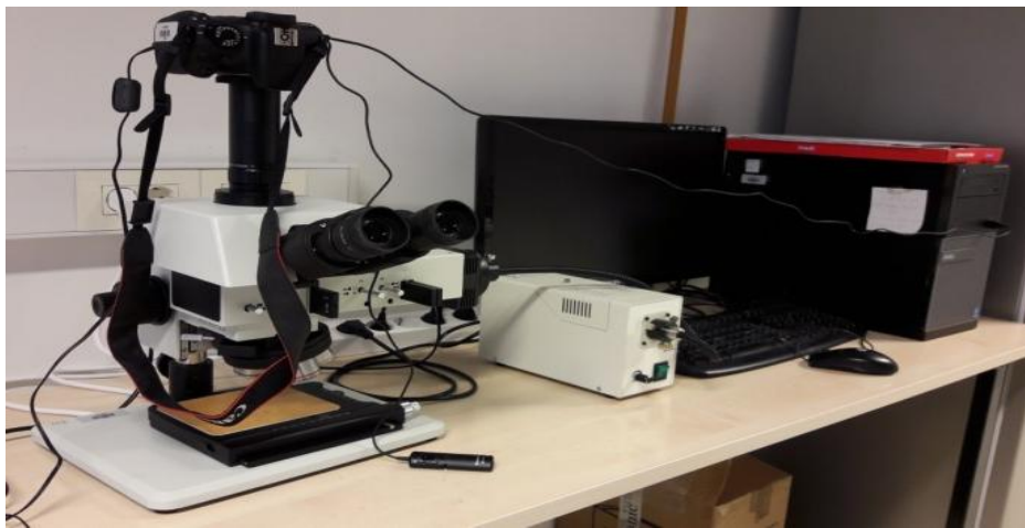
Slika 16. Svjetlosni mikroskop MXFMS-BD, Ningbo Sunny Instruments co. povezan s računalom
