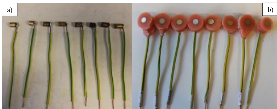
Slika 13. Izrada elektroda za elektrokemijska mjerenja
