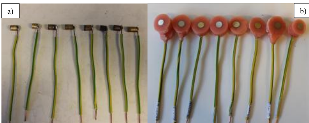
Slika 13. Izrada elektroda za elektrokemijska mjerenja
