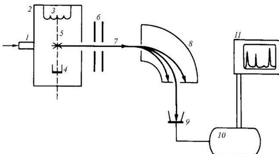
Slika 13. Shematski prikaz masenog spektrometra
