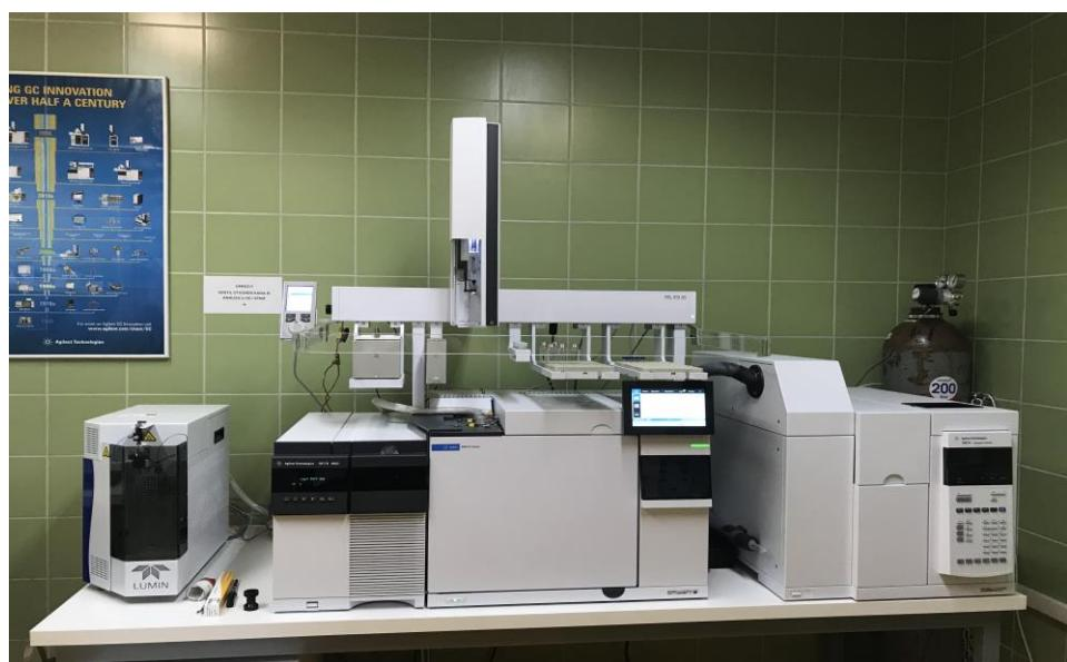
**Slika 19.** Vezani sustav plinska kromatografija-spektrometrija masa
