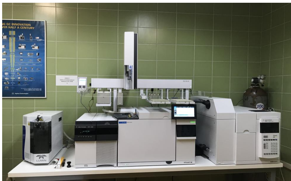
Slika 19. Vezani sustav plinska kromatografija-spektrometrija masa
