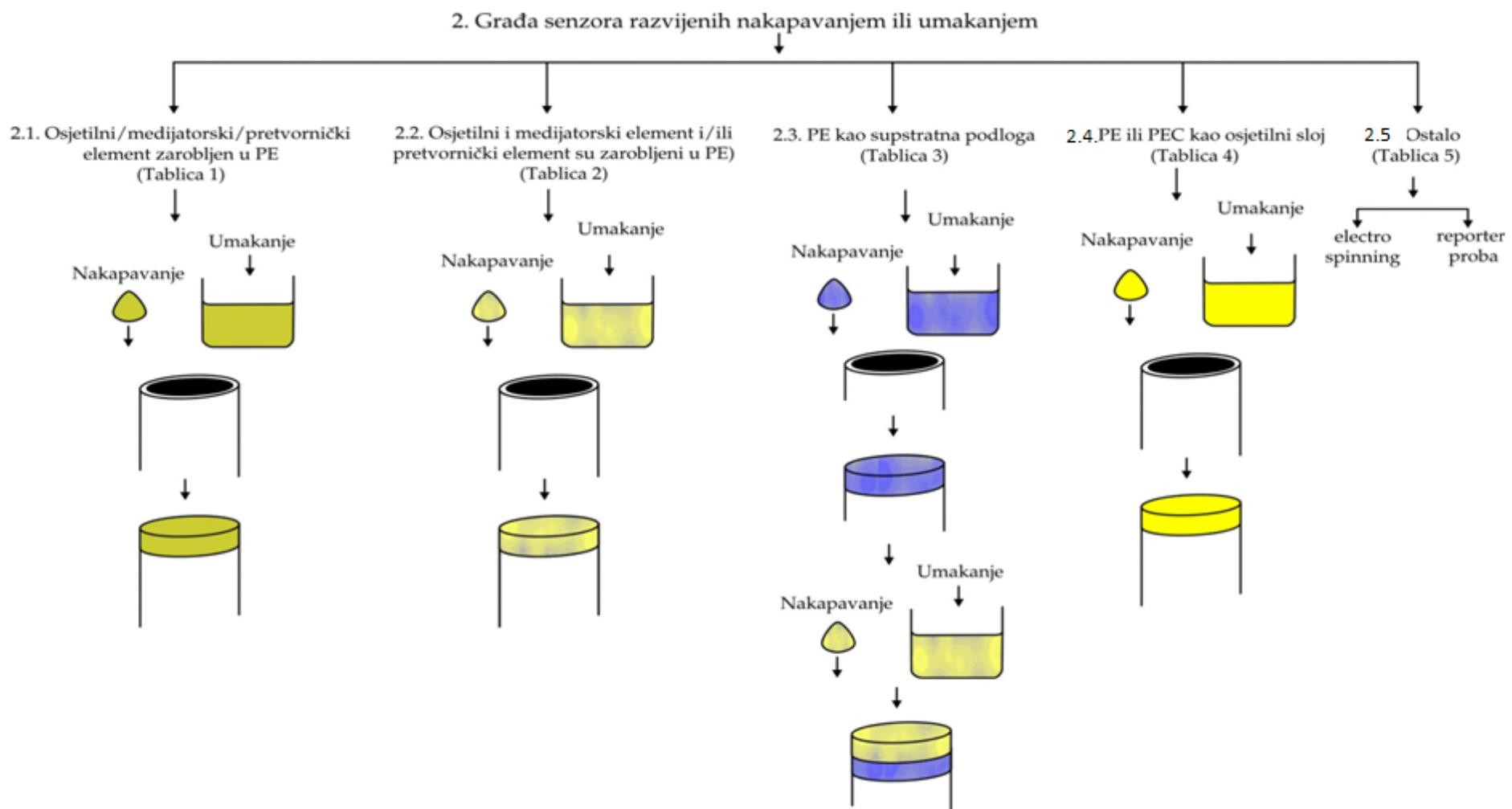
**Slika 2. Klasifikacija građe senzora obzirom na metodu nakapavanja i metodu umakanja u razvoju elektrokemijskih senzora (povezano tablicama koje slijede).**
