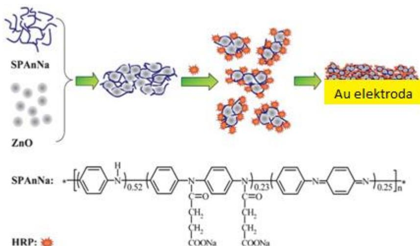
**Slika 3. Shematski prikaz HRP-SPAnNa-  $ZnO$ / Au elektrode [12].**
