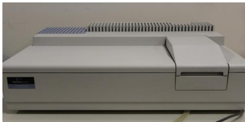
Slika 18. UV/VIS spektrofotometar PERKIN ELMER LAMBADA 25
