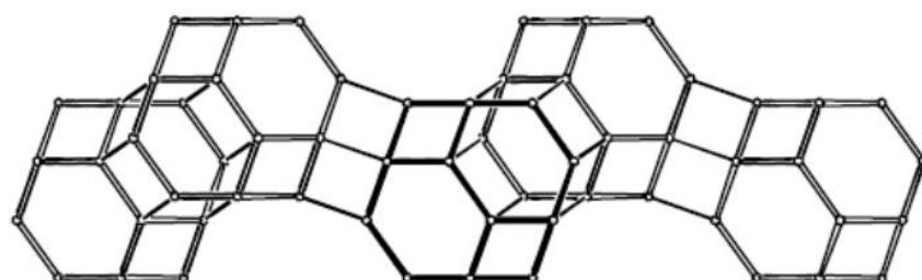
Slika 9. Struktura zeolita NaX<sup>7</sup>
