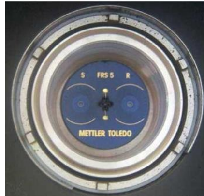
Slika 14. a) Diferencijalni pretražni kalorimetar DSC 823 e (Mettler Toledo, Švicarska) i b) mjerno osjetilo 37
