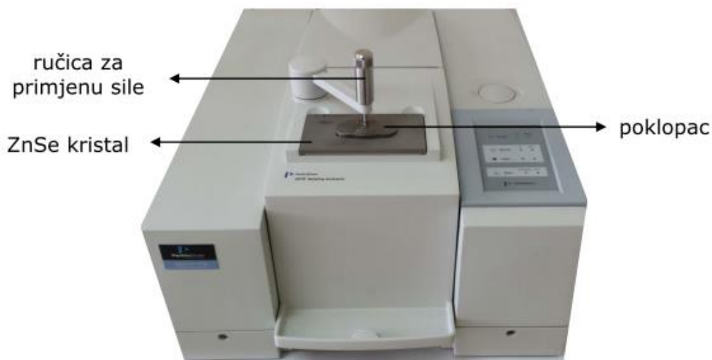
Slika 24. FT-IR spektrometar Spectrum One (Perkin-Elmer) s dodatkom za snimanje HATR tehnikom 26
