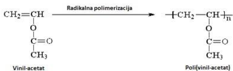
Slika 13. Polimerizacija iz vinil-acetata u PVAC 19
