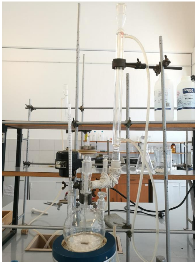
Slika 15. Aparatura za emulzijsku polimerizaciju vinil-acetata
