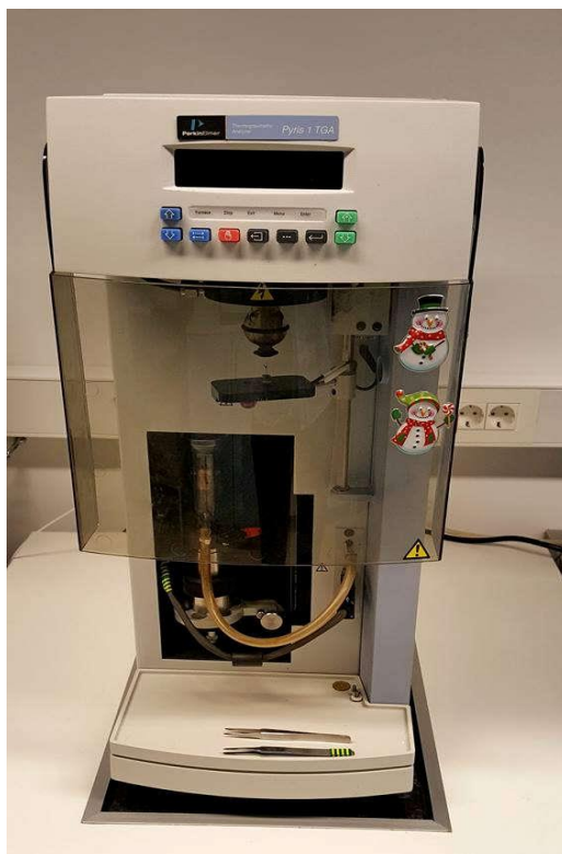
Slika 19. Termogravimetar Pyris TGA
