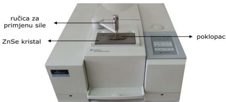
Slika 16. FT-IR spektrometar Spectrum One (Perkin–Elmer) s dodatkom za snimanje HATR tehnikom
